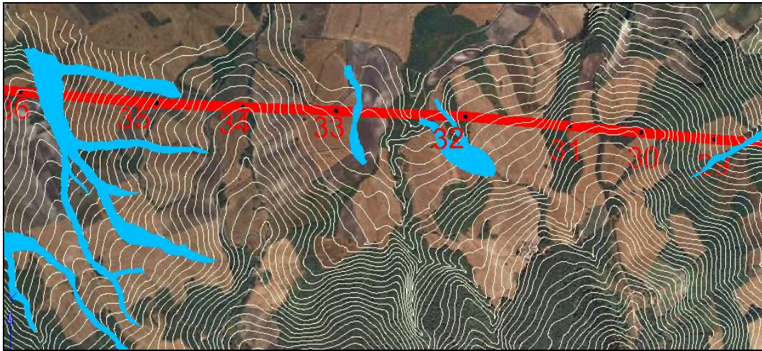
Dettaglio ortofoto e curve di livello con posizione tralicci dal n. 28 al n. 36 e floodplain tr 200 anni
