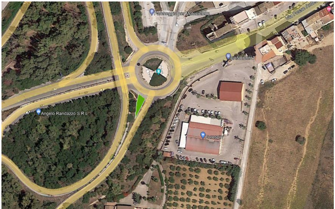
Allargamento della rampa di ingresso (direzione Est) sulla SS118
