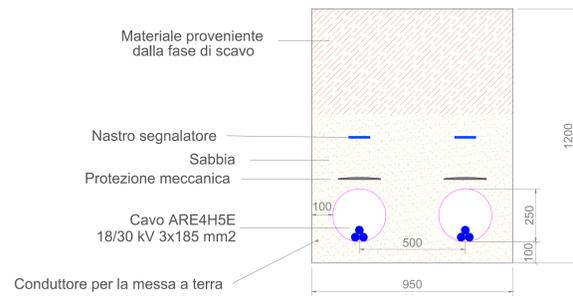
TIPOICO CAVIDOTTO M.T. INTERRATI – POSA INTERRATA A TRIFOGLIO IN TERRENO SU SEDE STRADALE
