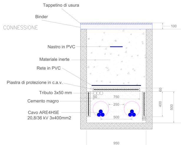
TIPOICO CAVIDOTTO A.T. ED M.T. INTERRATI – POSA INTERRATA A TRIFOGLIO IN TERRENO AGRICOLO
