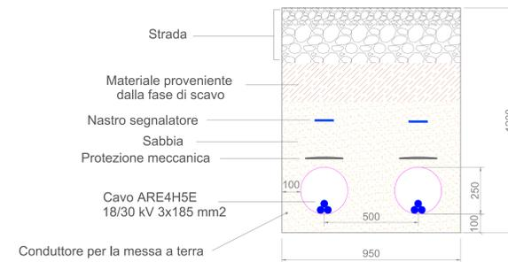
TIPOICO CAVIDOTTO A.T. INTERRATI – POSA INTERRATA A TRIFOGLIO IN TERRENO AGRICOLO
