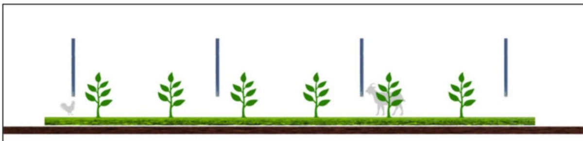
Figura 70 - Sistema agrivoltaico in cui i moduli fotovoltaici sono disposti verticalmente. La coltivazione avviene tra le file dei moduli fotovoltaici, l'altezza dei moduli da terra influenza il possibile passaggio di animali (TIPO3)
