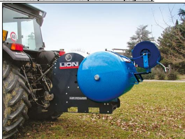
Figura 8.2: Compressore PTO per il funzionamento di strumenti pneumatici per l'arboricoltura e scuotitore motorizzato per la raccolta (Foto: Campagnola)
