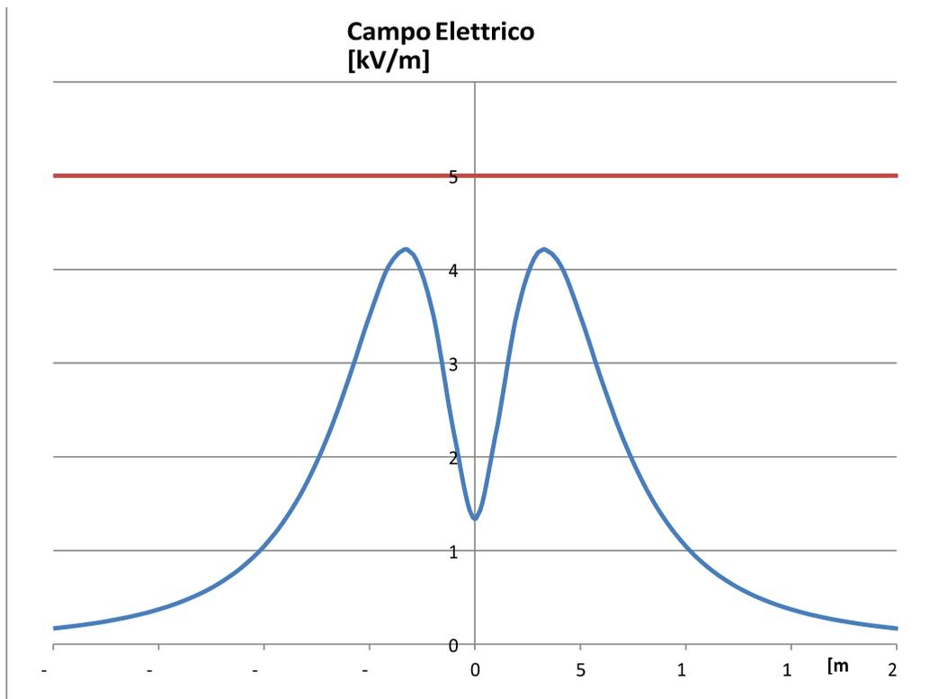
Figura 10: Campo elettrico al suolo generato dal sistema di sbarra a 150 kV
