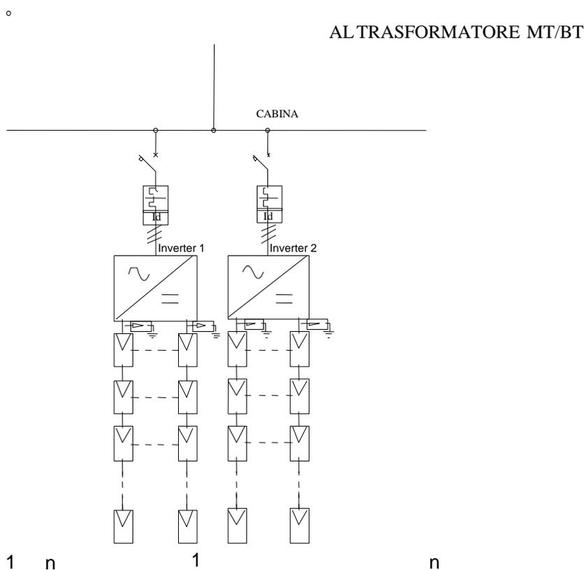
**Figura 10:** schema unifilare di principio dell'impianto fotovoltaico
