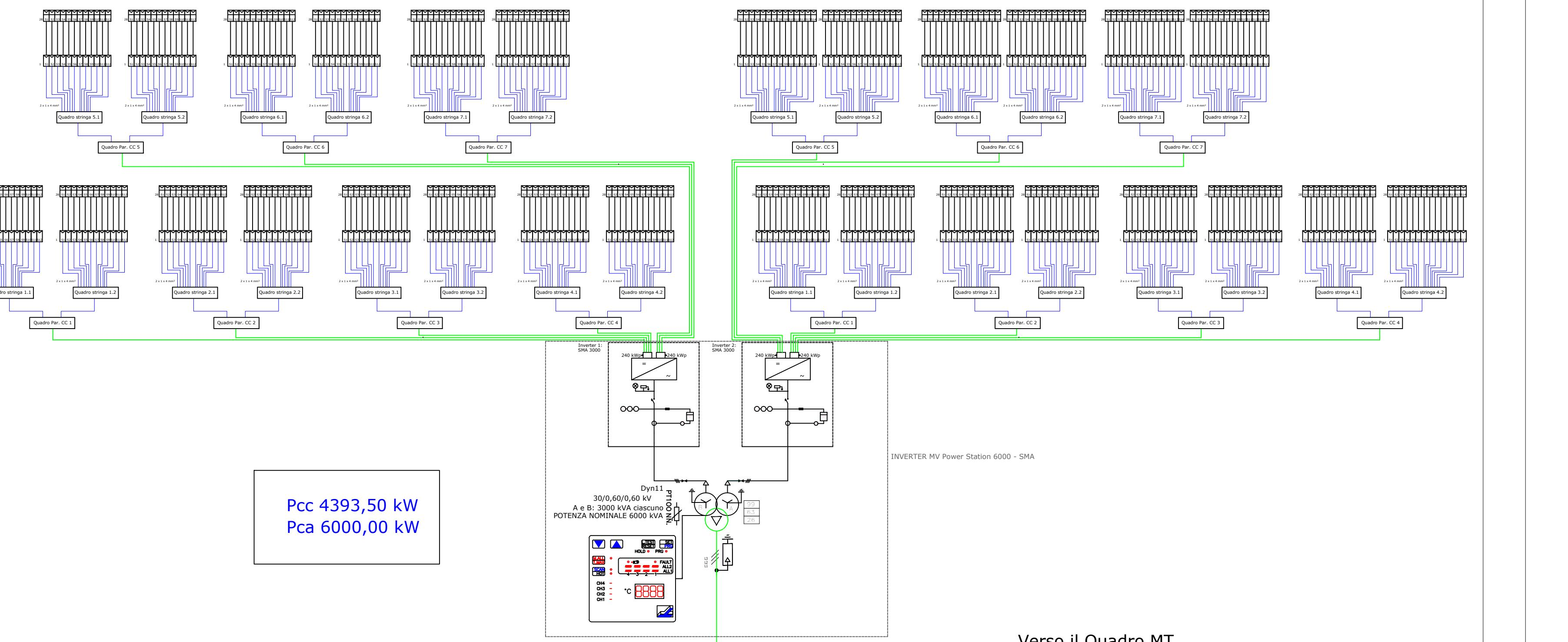
Schema Unifilare per BLOCCO da 6818,80 kWcc
