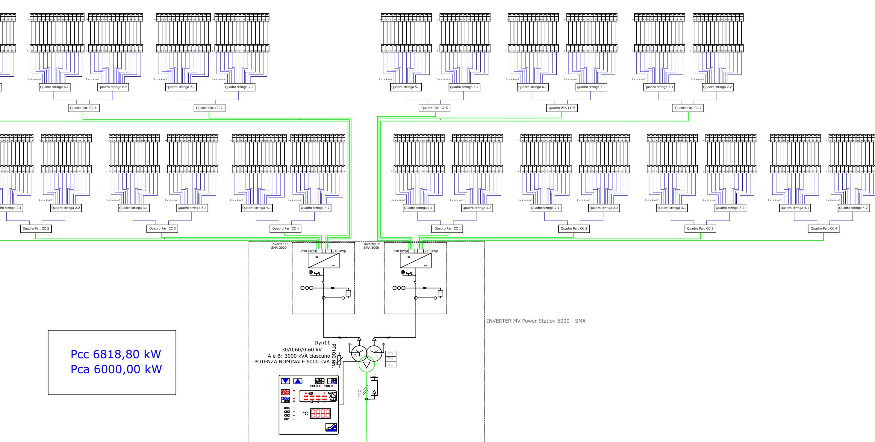
Schema Unifilare per BLOCCO da 6848,70 kWcc
