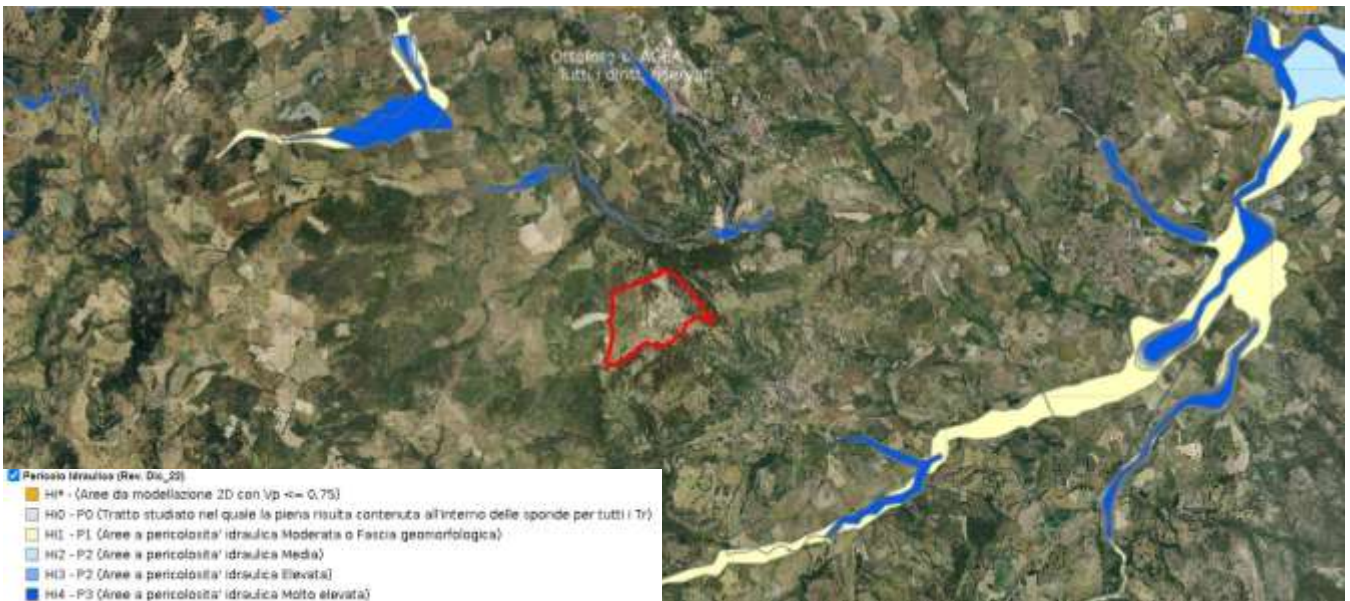
Fig. 80: Estratto PAI- Pericolo idraulico.
