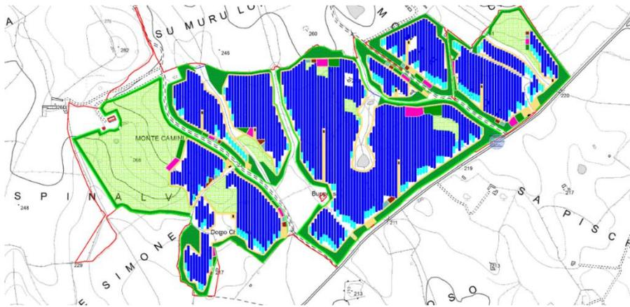
Fig. 45: Layout del progetto per la realizzazione dell'impianto agri-voltaico "FV\_TULA"
