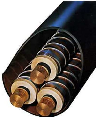
Figura 5 Cavi con isolamento in carta impregnata di olio fluido contenuti in tubo d'acciaio
