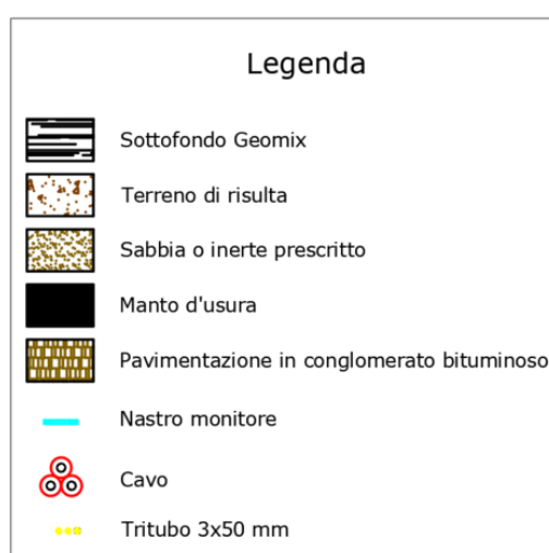
Figura 12 – Materiali di riempimento per scavo cavi esterni
