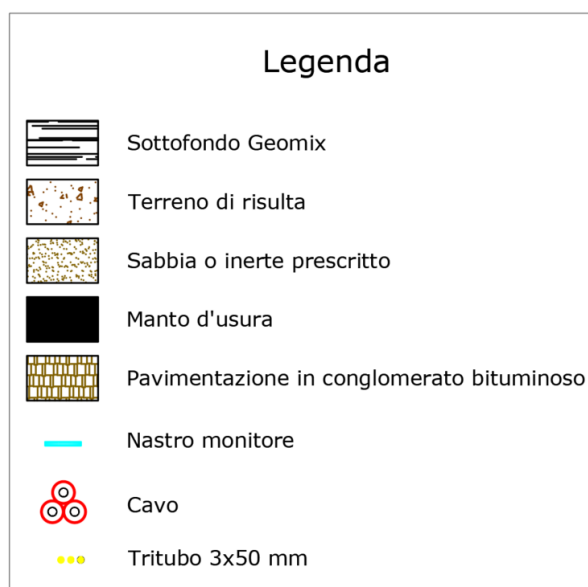
Figura 4: Materiali di riempimento per tipologia di scavo
