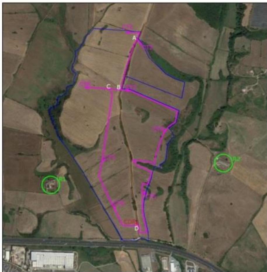
*Figura 105 - Layout dell'impianto con indicazione dei cavidotti interni e dei ricettori potenzialmente sensibili*
