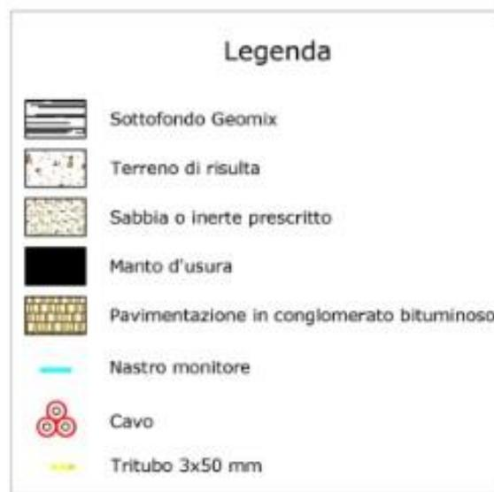
Figura 46 - Materiali di riempimento per tipologia di scavo
