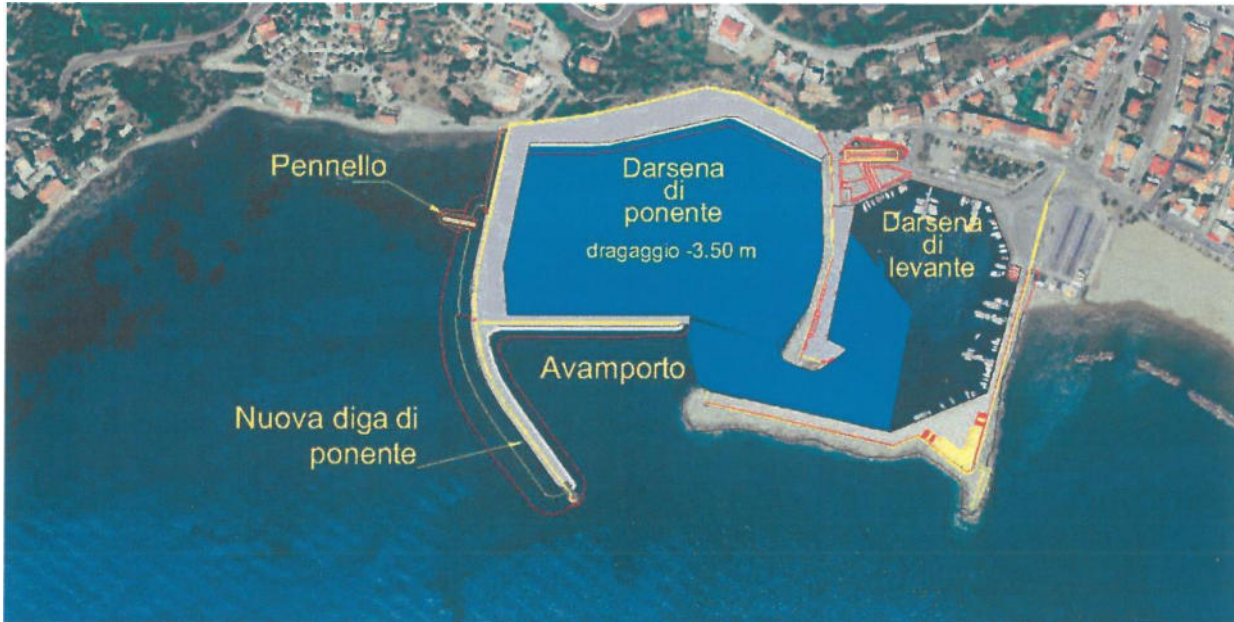
Figura 3:ALTERNATIVA PROGETTUALE 2 :Assetto planimetrico della riqualificazione e completamento del porto di Casal Velino 2013.
