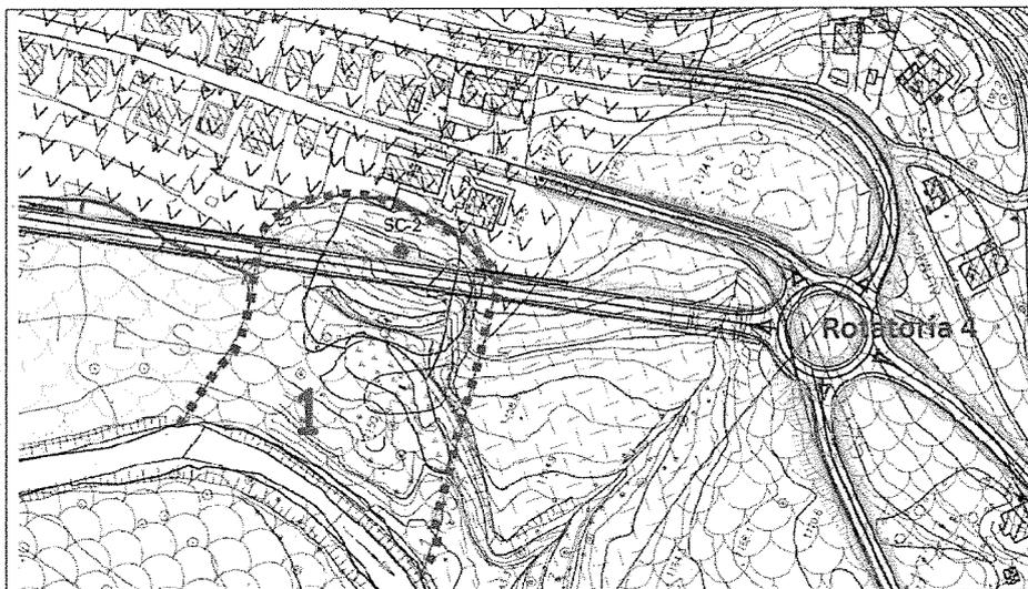
**CONSIDERATO** che il progetto per la **Frana attiva n. 1** prevede di inserire una paratia di pali a monte del corpo stradale ed un muro di sostegno su pali a valle, con interventi di drenaggio e di tirantatura, con lo scopo di considerarli propedeutici alla realizzazione di una profonda bonifica del piano di appoggio del rilevato (come da particolari e sezioni di progetto) al fine di sostituire la parte più superficiale e rimaneggiata del corpo franoso;
