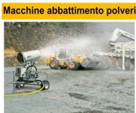
Figura 11-3: Nebulizzatore per abbattimento polveri
