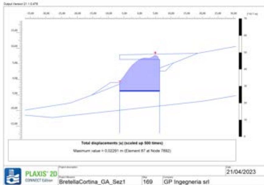
Figura 7-41: SEZ TIPO 1 – Soletta inferiore – Spostamento massimo
