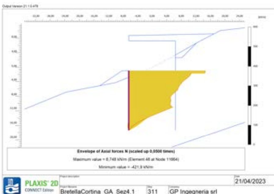
Figura 7-113: SEZ TIPO 4 – Palo di valle – Sforzo normale (N) dimensionante
