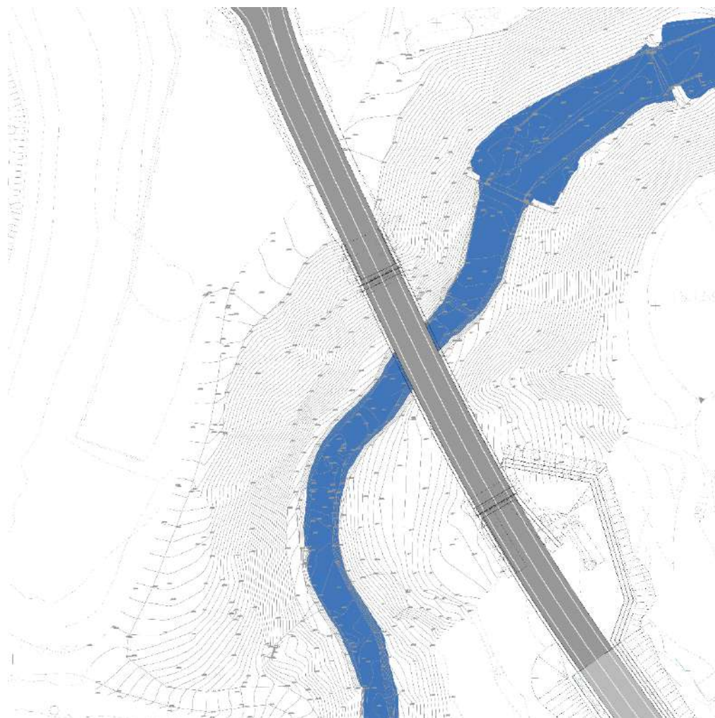
Figura 2-2 – Attraversamento Torrente Bigontina – planimetria aree di esondazione T_r = 200 anni
