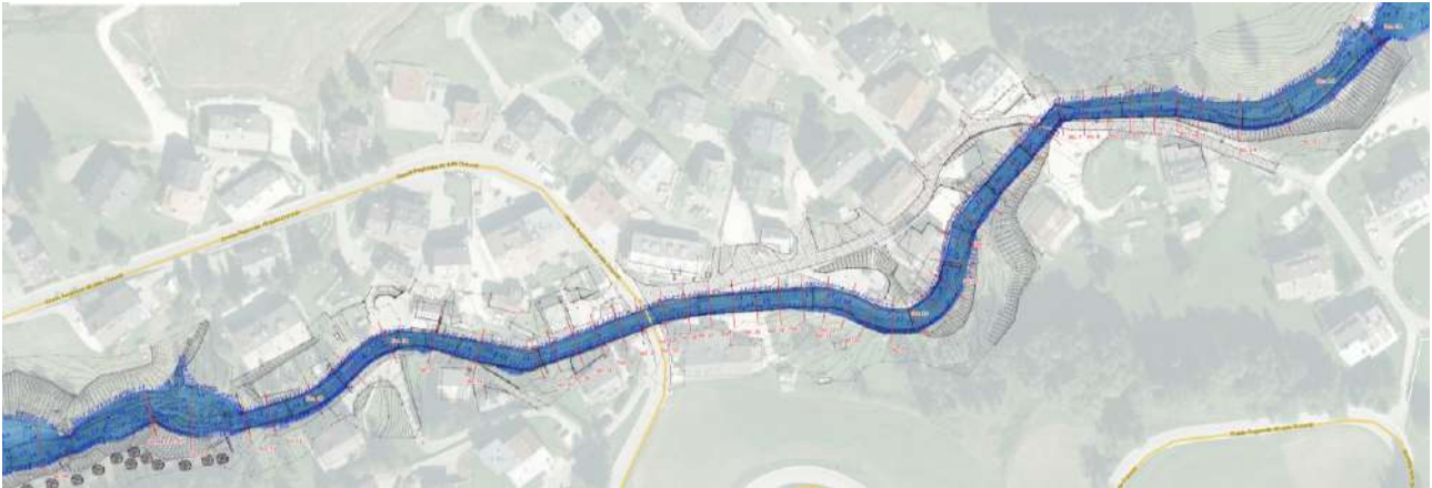
Figura 9.7 –Massime altezze della colata di detrito per Tr 300 anni (evento maggiormanete gravoso tra quelli esaminati) – Tratto di Alverà
