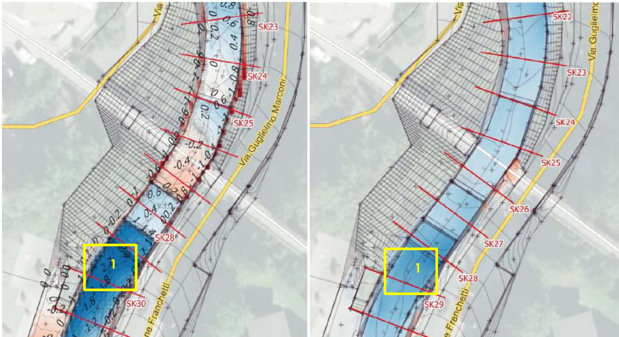
Figura 6.19 – Simulazione evento 4-5 Agosto 2017 – scavi (rosso) e depositi (blu) a monte del ponte SR 48 - Modello di colata detritica TRENT 2D (destra) e modello di trasporto solido BASEMENT sinistra
