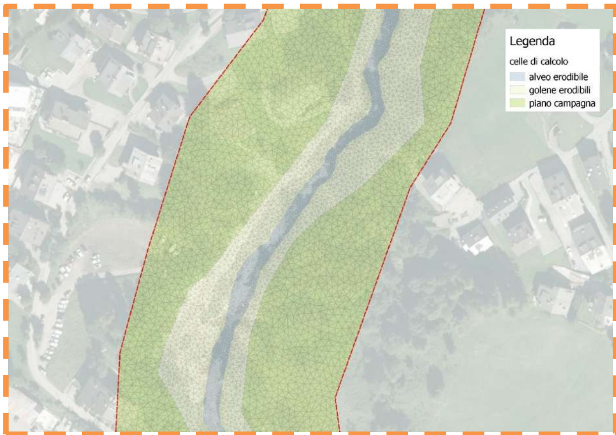
Figura 5.7 – Domino 02 – CORTINA – Stralcio Definizione delle condizioni al contorno, della scabrezza e dell'erodibilità del substrato
