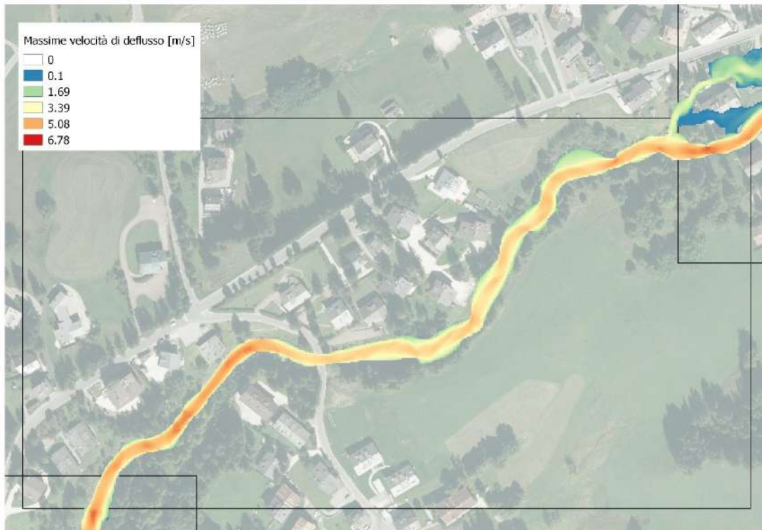
Figura 7.45 – Simulazione evento con Tr 300 anni – Massime velocità di deflusso – Tratto da Alverà a Pecol
