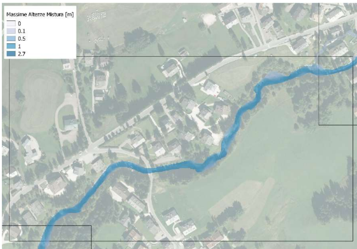
Figura 7.33 – Simulazione evento con Tr 100 anni – Massimi tiranti della mistura – Tratto da Alverà a Pecol
