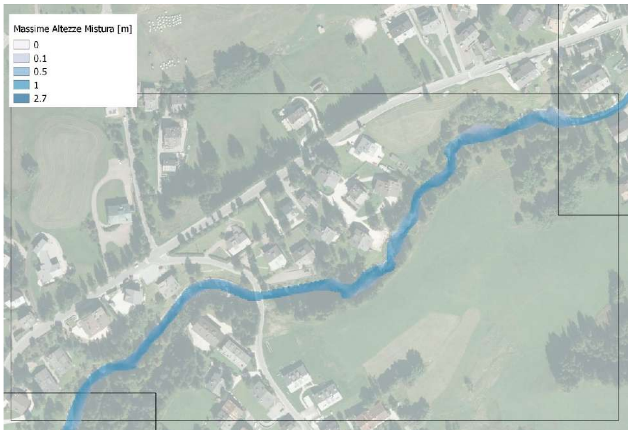
Figura 7.22 – Simulazione evento con Tr 30 anni – Massimi tiranti della mistura – Tratto da Alverà a Pecol
