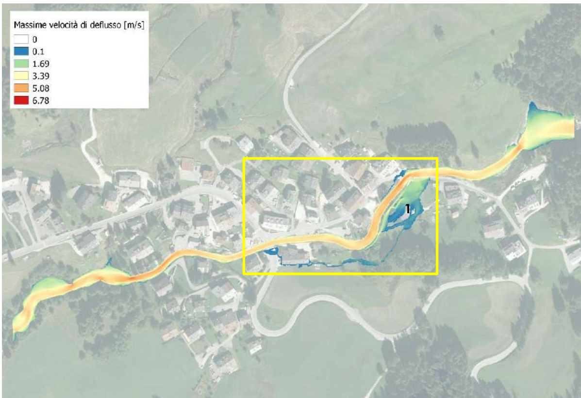
Figura 9.4 –Massime velocità di deflusso nel caso di ostruzione del ponte comunale a monte dell'abitato di Alverà, Colata di detrito con T_r300 anni dopo la realizzazione degli interventi previsti
