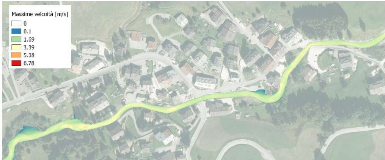
Figura 7.13 – Simulazione evento con Tr 100 anni – Massime velocità di deflusso
