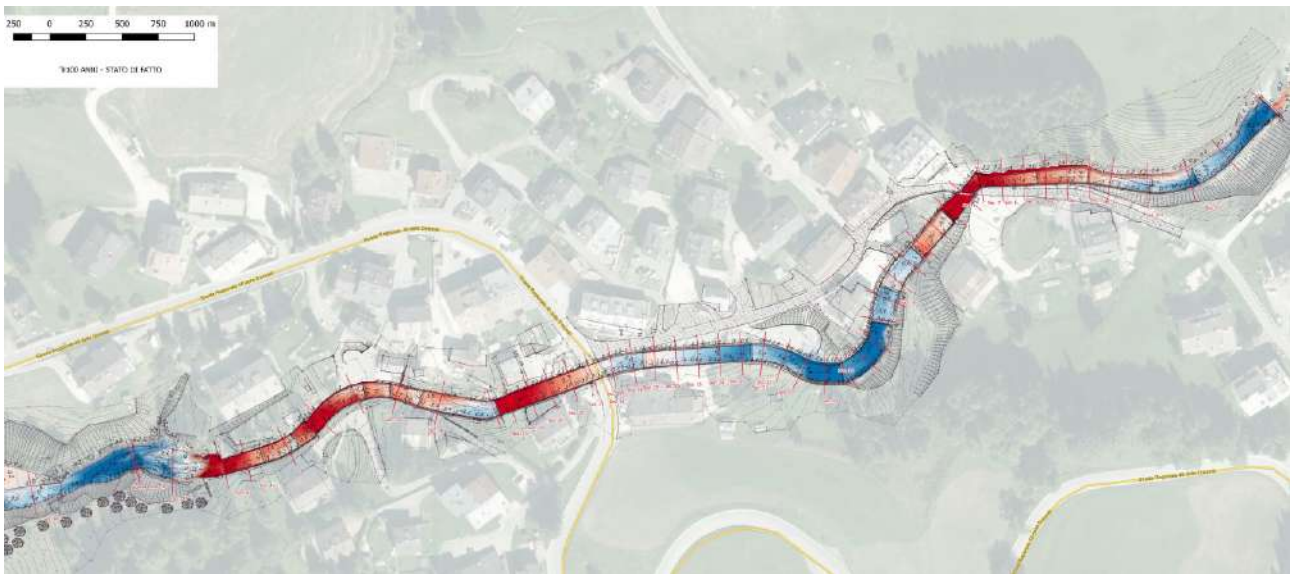
Figura 7.9 – Simulazione evento con Tr 300 anni – Scavi (in rosso) e depositi (in blu) all'istante finale della simulazione
