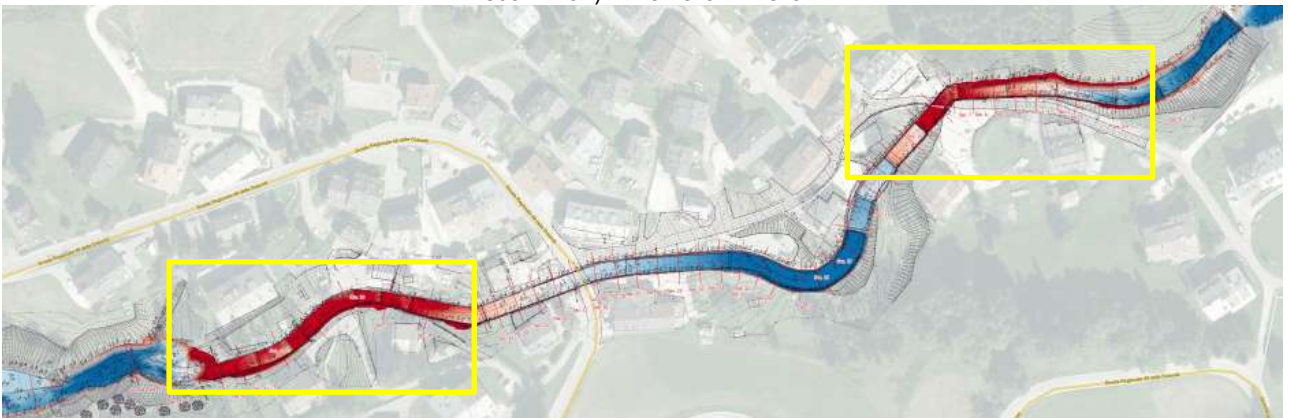
Figura 9.8 –Scavi e depositi della colata di detrito per Tr 300 anni (evento maggiormanete gravoso tra quelli esaminati) – Tratto di Alverà – Sono indicati i tratti soggetti ad erosione
