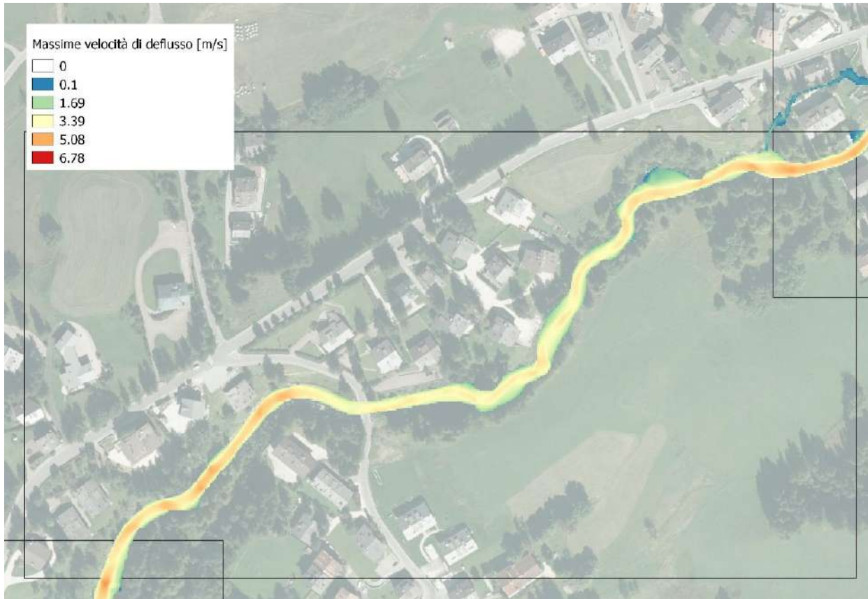
Figura 7.34 – Simulazione evento con Tr 100 anni – Massime velocità di deflusso - Tratto da Alverà a Pecol
