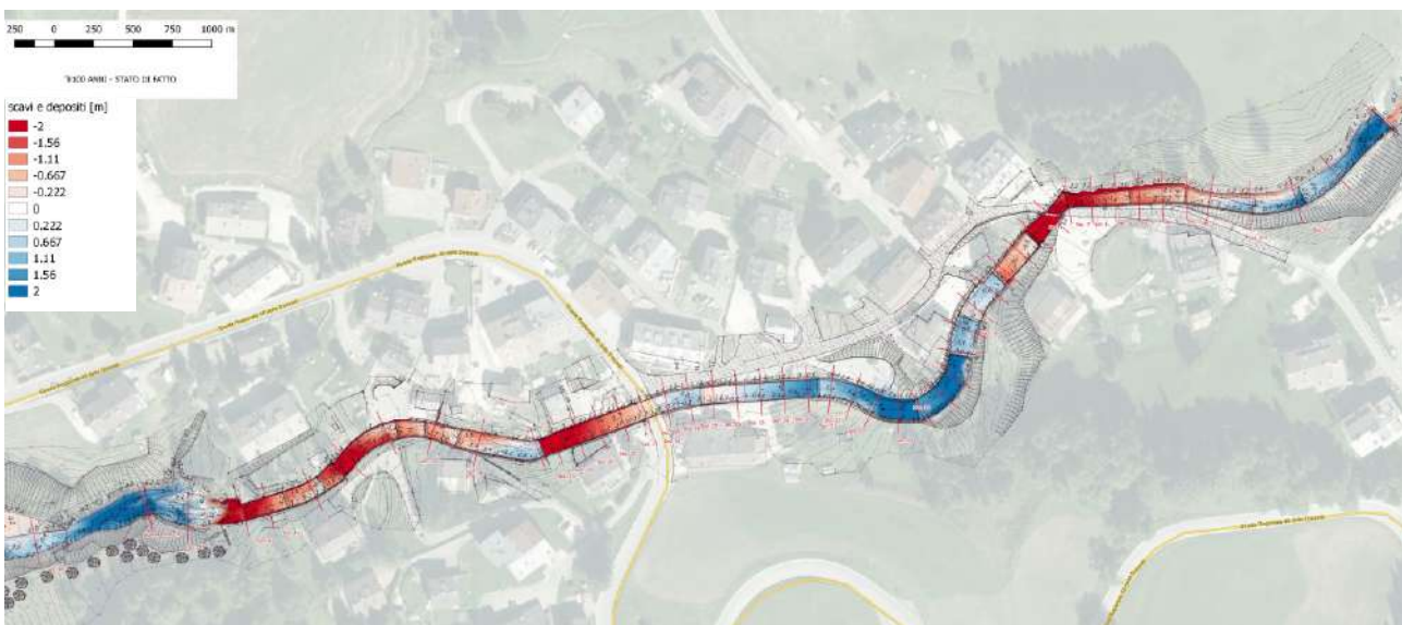
Figura 7.14 – Simulazione evento con Tr 100 anni – Scavi ( in rosso) e depositi (in blu) all'istante finale della simulazione
