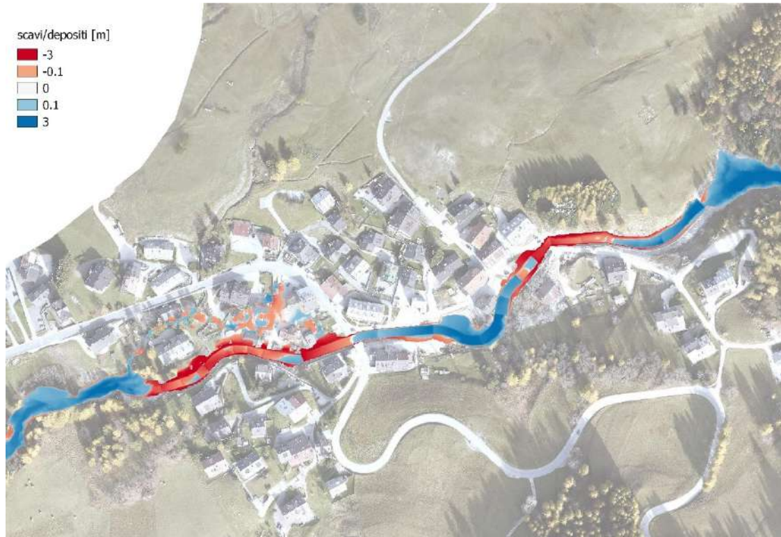
Figura 7.19 – Simulazione evento con Tr 300 anni – Scavi ( in rosso) e depositi (in blu) all'istante finale della simulazione
