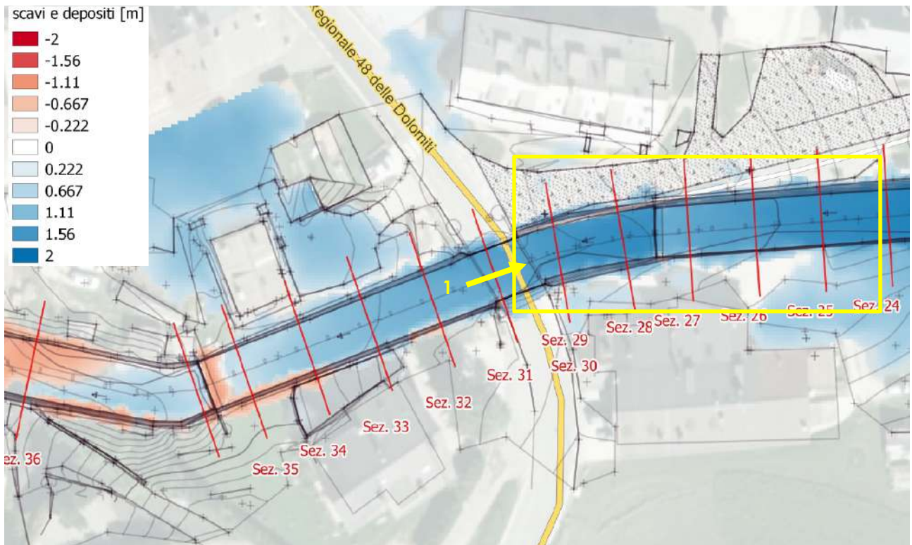
Figura 6.12 – Simulazione evento 4-5 Agosto 2017 – scavi (rosso) e depositi (blu) a monte del ponte SR 48 - Modello di trasporto solido BASEMENT
