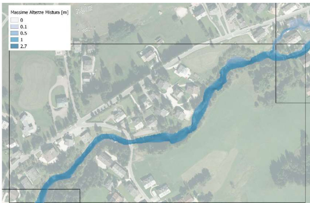
Figura 7.44 – Simulazione evento con Tr 300 anni – Massimi tiranti della mistura – Tratto da Alverà a Pecol
