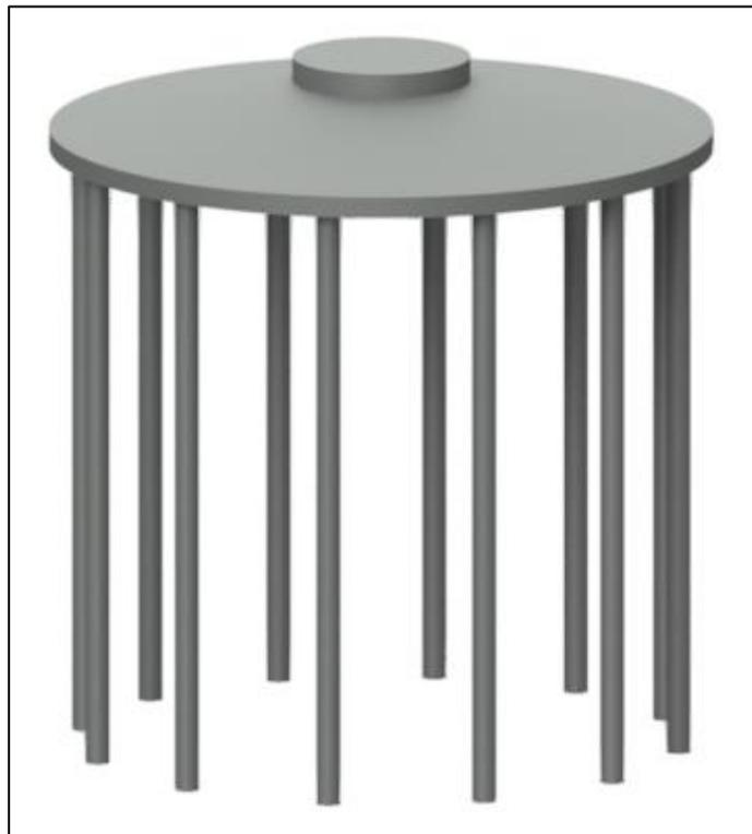
Figura 8: vista tridimensionale della fondazione dell'aerogeneratore
