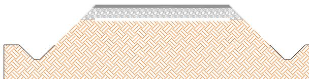
*Fig. 9 - Sezione tipo tratto in rilevato*
