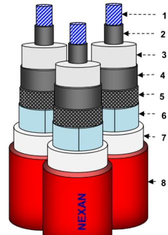
Il cavo è adatto alla posa direttamente interrata, ha il conduttore in alluminio ed è cordato ad elica.
