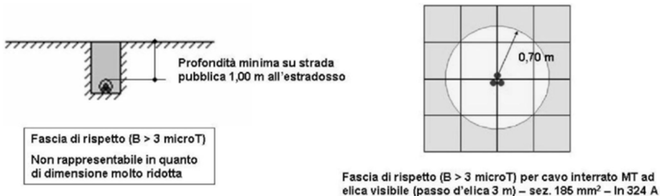
Figura 2: Posizionamento cavi interrati
