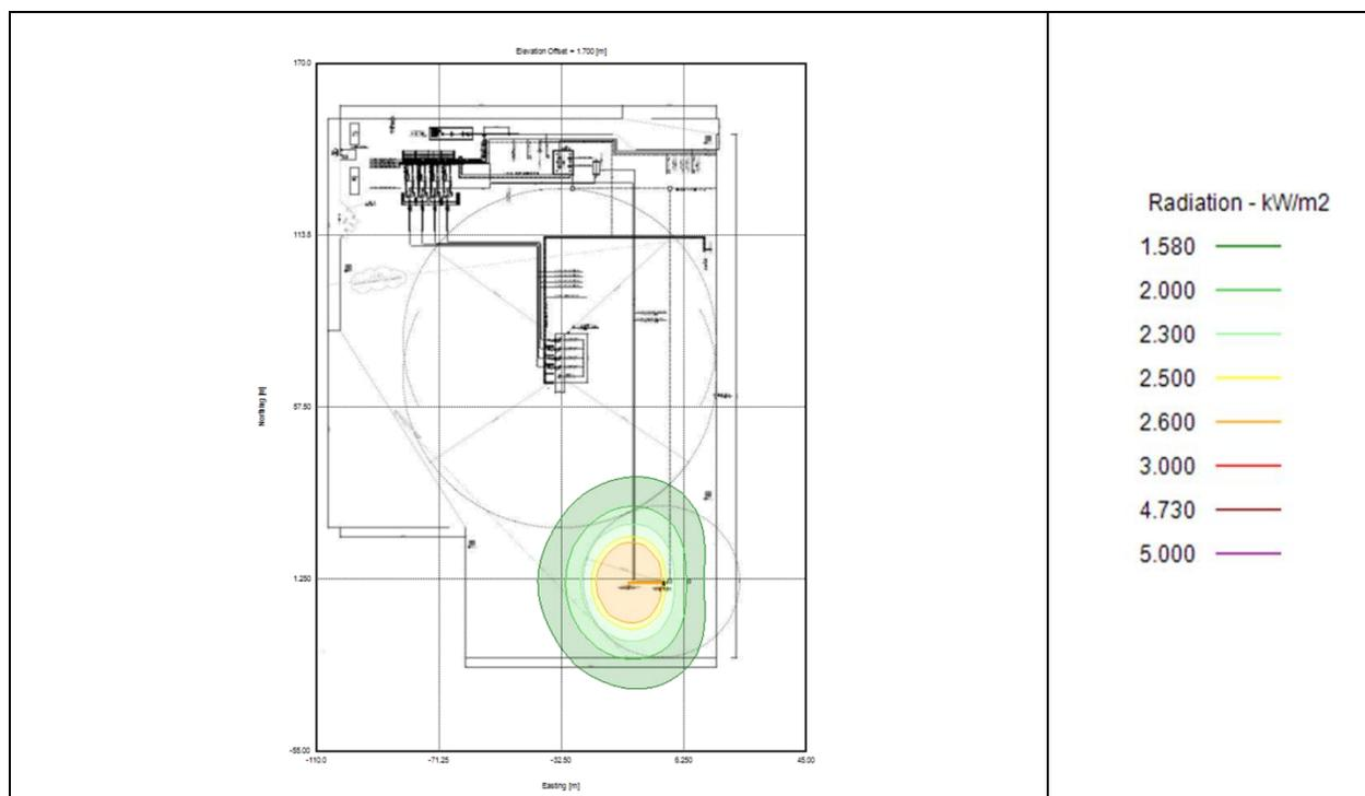
Figura 2 - Mappa di irraggiamento - Pianta
