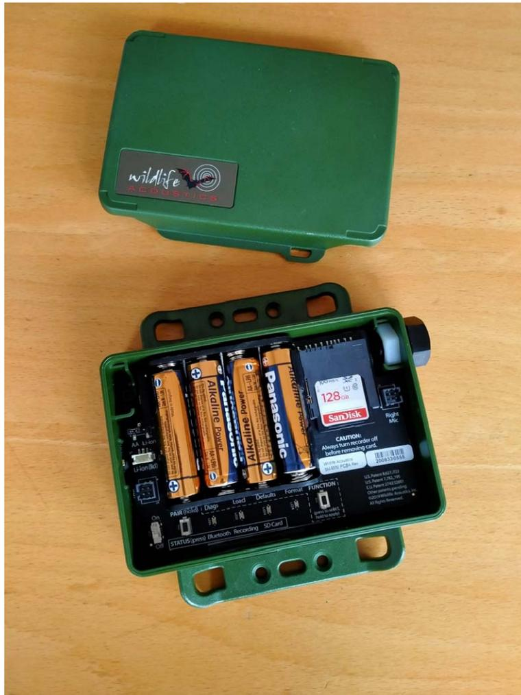
*Fig. 2.5/B. Il modello di bat-detector utilizzato per il monitoraggio della chiroterofauna*
