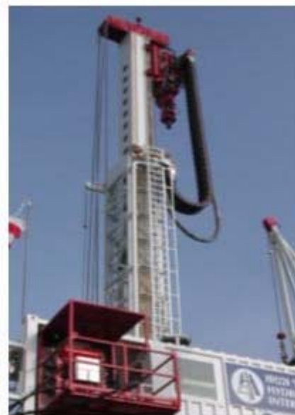
Figura 3-34 Impianto di perforazione HH220: sistema di sollevamento
