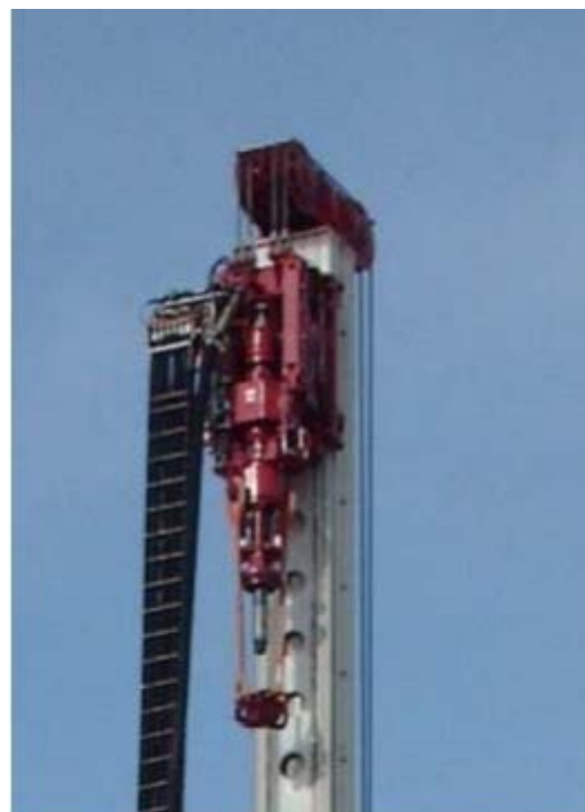
Figura 3-35 Impianto di perforazione HH220: top drive
