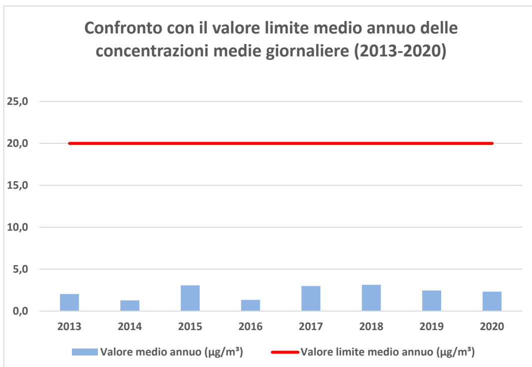
Figura 6-3 Confronto con il valore limite medio annuo delle concentrazioni medie giornaliere (2013-2020) - SO 2
