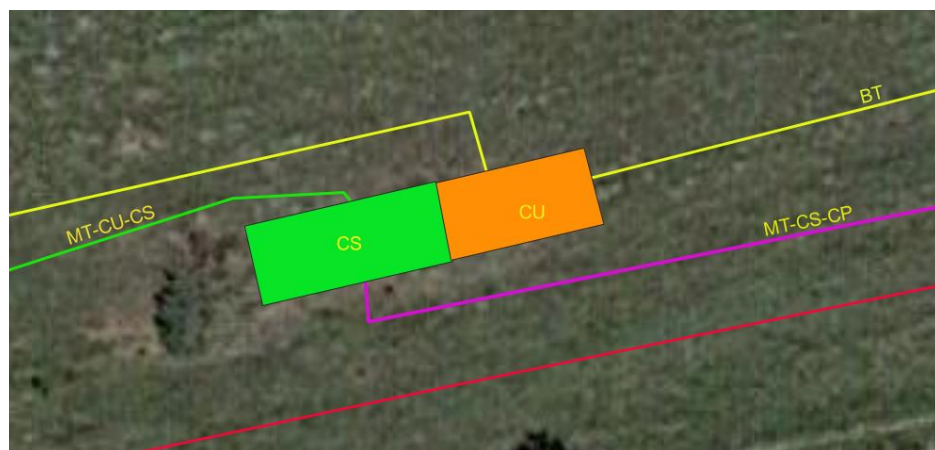
Figura 26: Dettaglio Cabina di consegna CS e cabina di conversione CU
