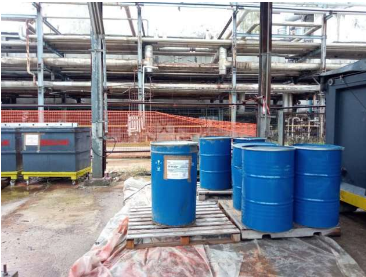
Foto 3: Esempio di aree non separate tra rifiuti e aree di magazzino, di fusti di rifiuti privi di etichettatura in area non delimitata (area di deposito temporaneo 2).
