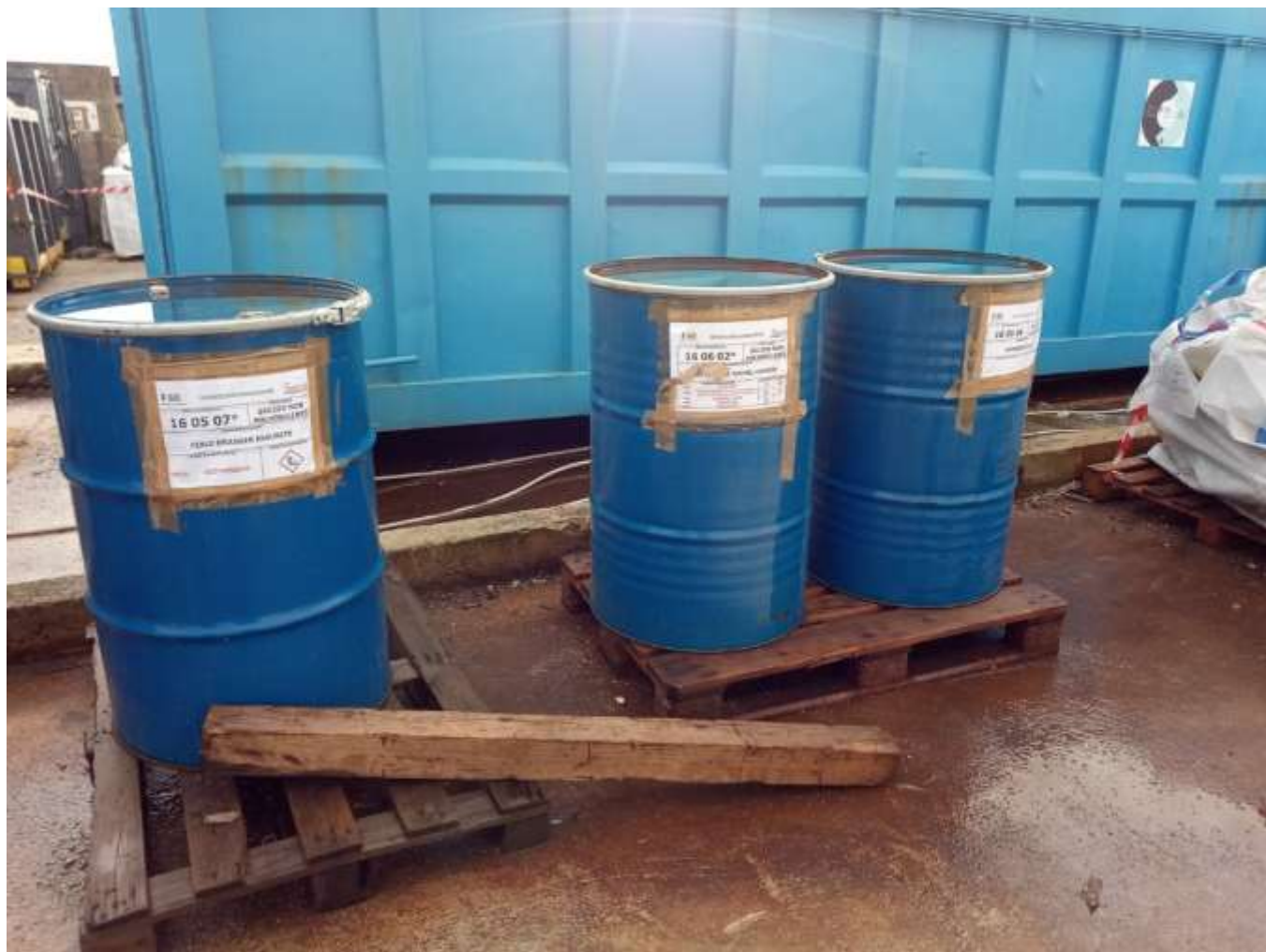
Foto 6: Esempio, nell'area di deposito temporaneo di rifiuti n.1, di contenitori (fusti) contenenti rifiuti pericolosi (EER 160507* e EER160602*) e non pericolosi (EER160604) nelle immediate vicinanze e senza nastratura e chiara separazione.
