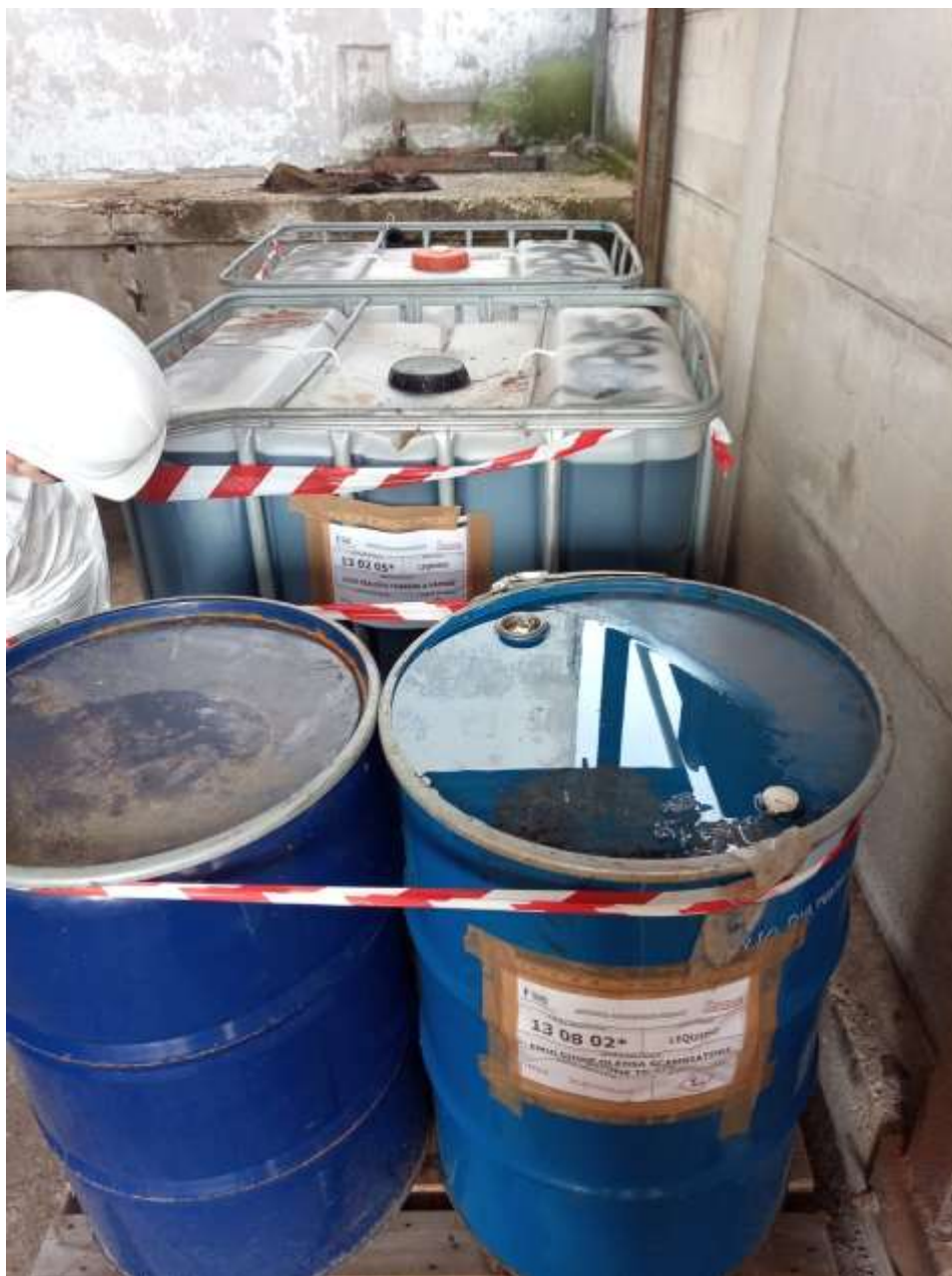
Foto 2: Esempio di area non idoneamente delimitata (nastro rosso) con big bags e fusti con etichetta non leggibile (area di deposito temporaneo 1).
