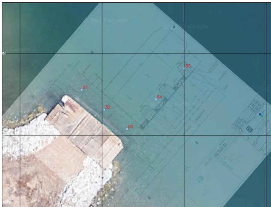
Figura 2-2 Pontile secondario - schema di campionamento per la definizione della granulometria dei sedimenti marini
