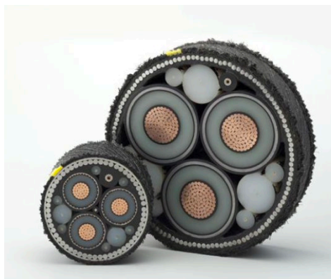
Figura 7.13: sezione di un cavo marino tripolare con isolamento in XLPE e armatura in acciaio
