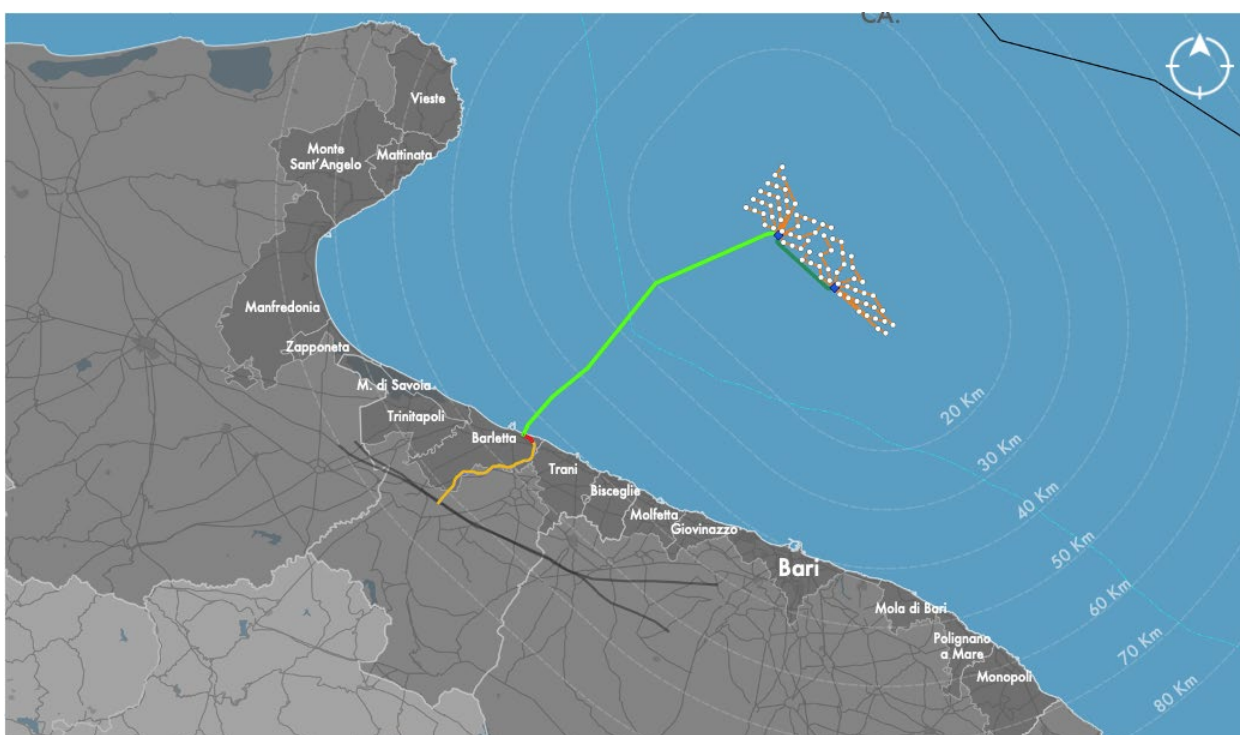
Figura 4.1: inquadramento su ortofoto dell'impianto eolico offshore galleggiante
