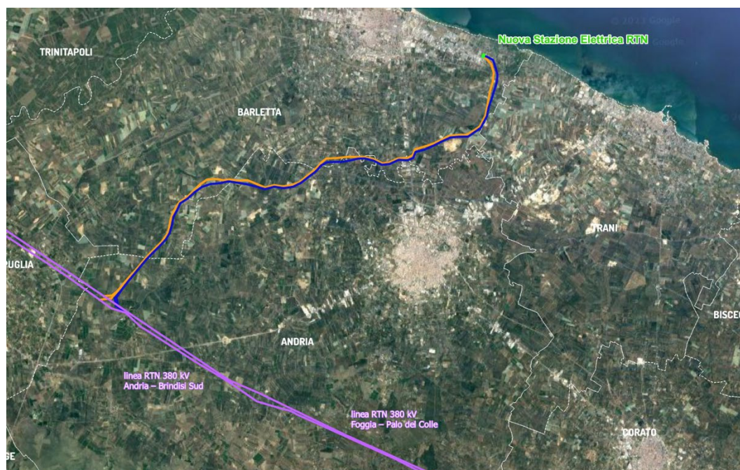
Figura 7.17 Tracciato degli elettrodotti
