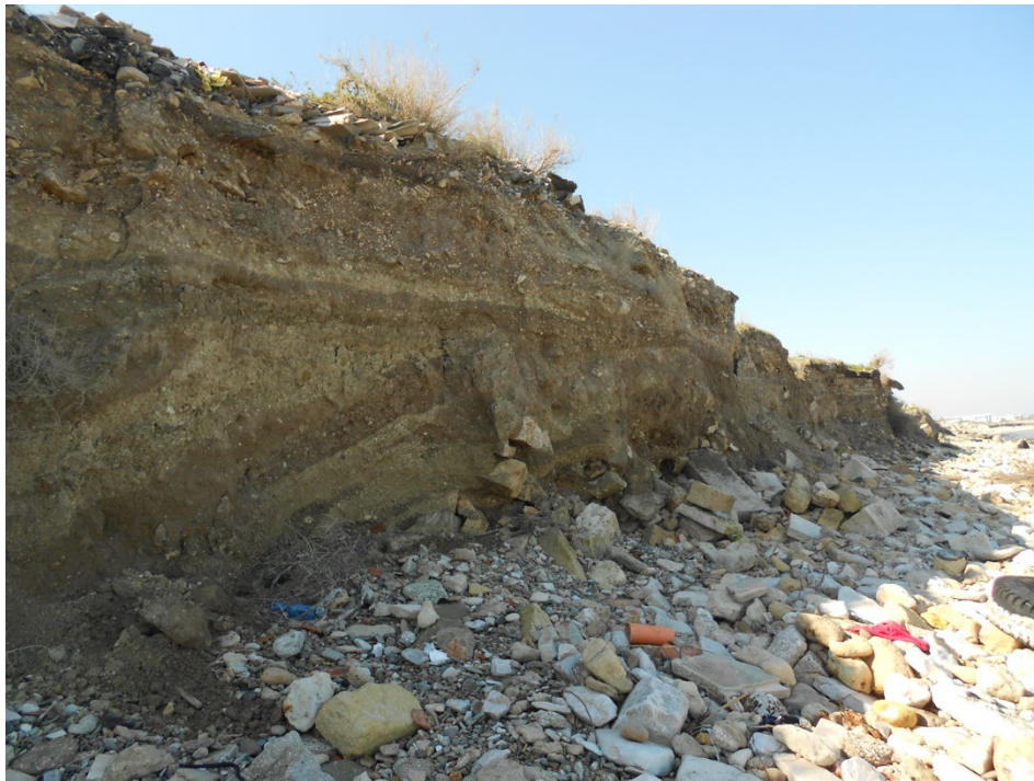
Foto 10 – Ripa di erosione costiera intagliata in depositi antropici (materiali di risulta) località Belvedere - litoranea di Levante di Barletta
