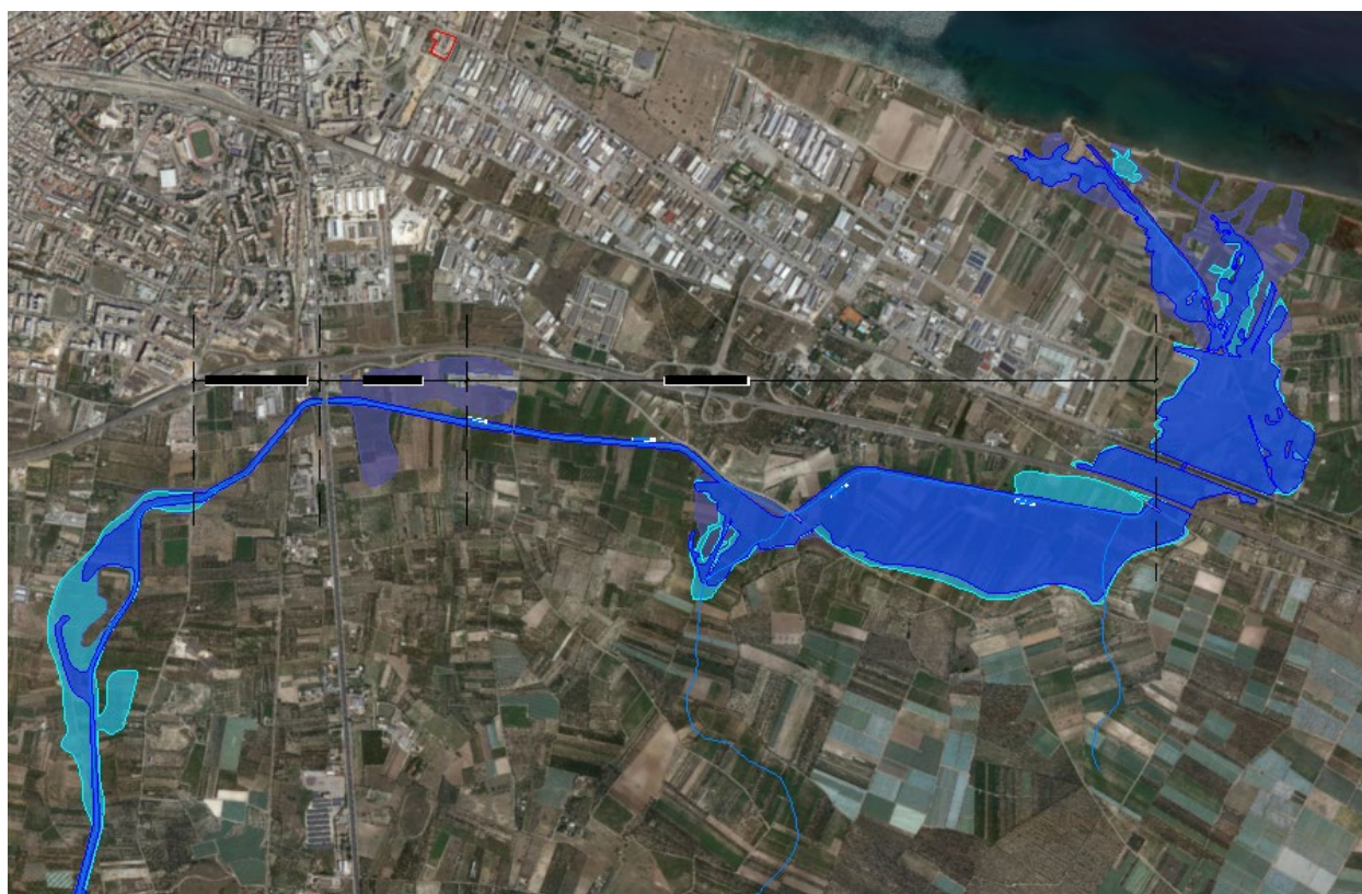
Planimetria con perimetrazione post-operam interventi progettati
