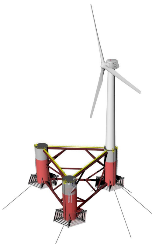
Figura 15: Configurazione semisommergibile WindFloat da 2 MW [17] – la configurazione semisommergibile da 15 MW proposta in questo rapporto si basa su questa e su altre simili di dimensioni maggiori (vedere la sezione 6.2.1)
