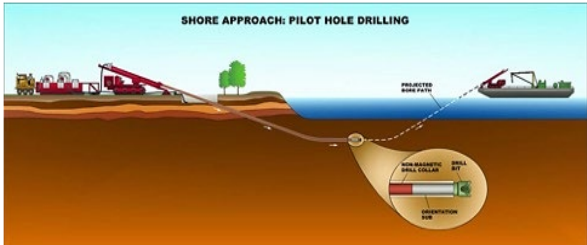
Posa del cavo nel punto di sbarco con tecnica TOC
