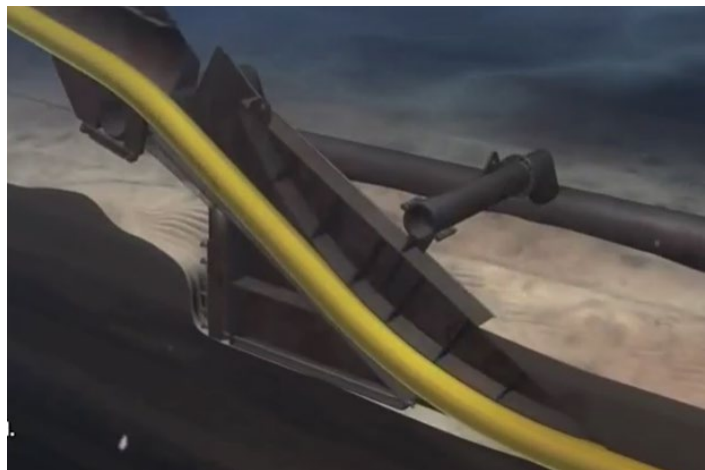
Aratro marino e schema della trincea di scavo
