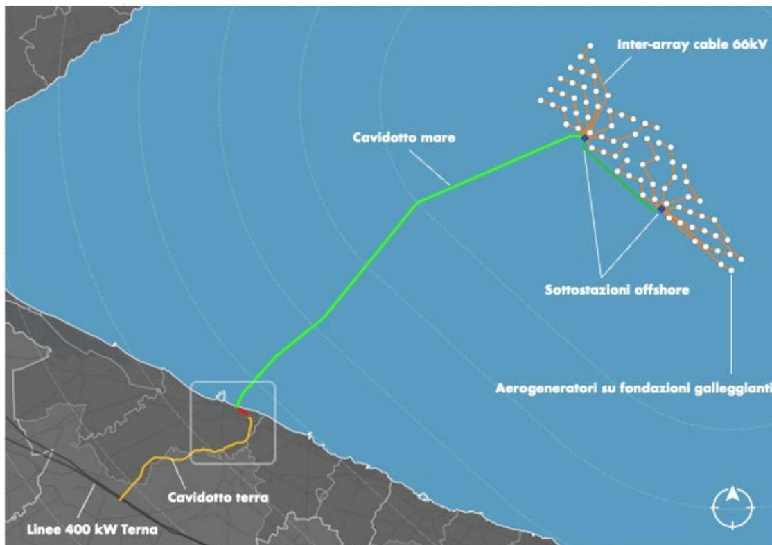
Per quanto riguarda la localizzazione delle opere a terra, queste sono strettamente connesse alla necessità di collegare l'impianto eolico offshore alla rete di trasmissione nazionale gestita da TERNA spa. La soluzione tecnica di connessione indicata da TERNA con preventivo di connessione Codice Pratica: 202102517 prevede
