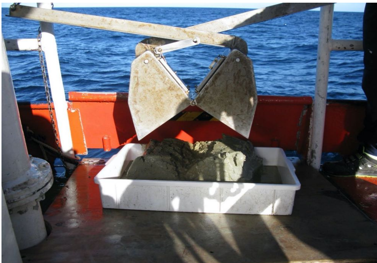
Fig. 3.D – Benna Van Veen con capacità da 20 litri utilizzata per il prelievo dei sedimenti e del macrozoobenthos nel corso dei campionamenti effettuati nell'area di studio.
