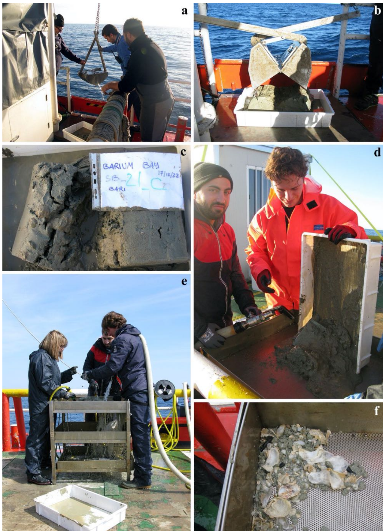
Fig. 5.1.1.A – Fasi del campionamento del sedimento e del macrobenthos. a) Salpaggio della benna van Veen a bordo dopo aver prelevato il sedimento; b) svuotamento del contenuto della benna in vasconi di plastica; c) etichettatura del campione; d) svuotamento del sedimento su tavolo a setacci multipli utilizzato per la cernita ed il prelievo degli organismi bentonici; e) fase di setacciatura del sedimento; f) materiale biologico setacciato da un campione.
