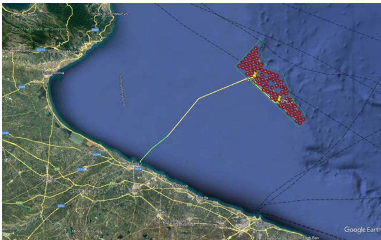
Figura 1. Area di studio con indicazione del cavidotto (approdo con microtunnel; linea continua verde, posa in appoggio; linea continua gialla, posa con realizzazione di trench), delle sotto-stazioni off-shore (Sottostazione 1 e 2 indicate rispettivamente dai segnaposti kml_1 e kml_2) e del parco eolico (posizione delle turbine rappresentata dai cerchi rossi vuoti), nonché delle principali rotte marittime (linee nere tratteggiate).
