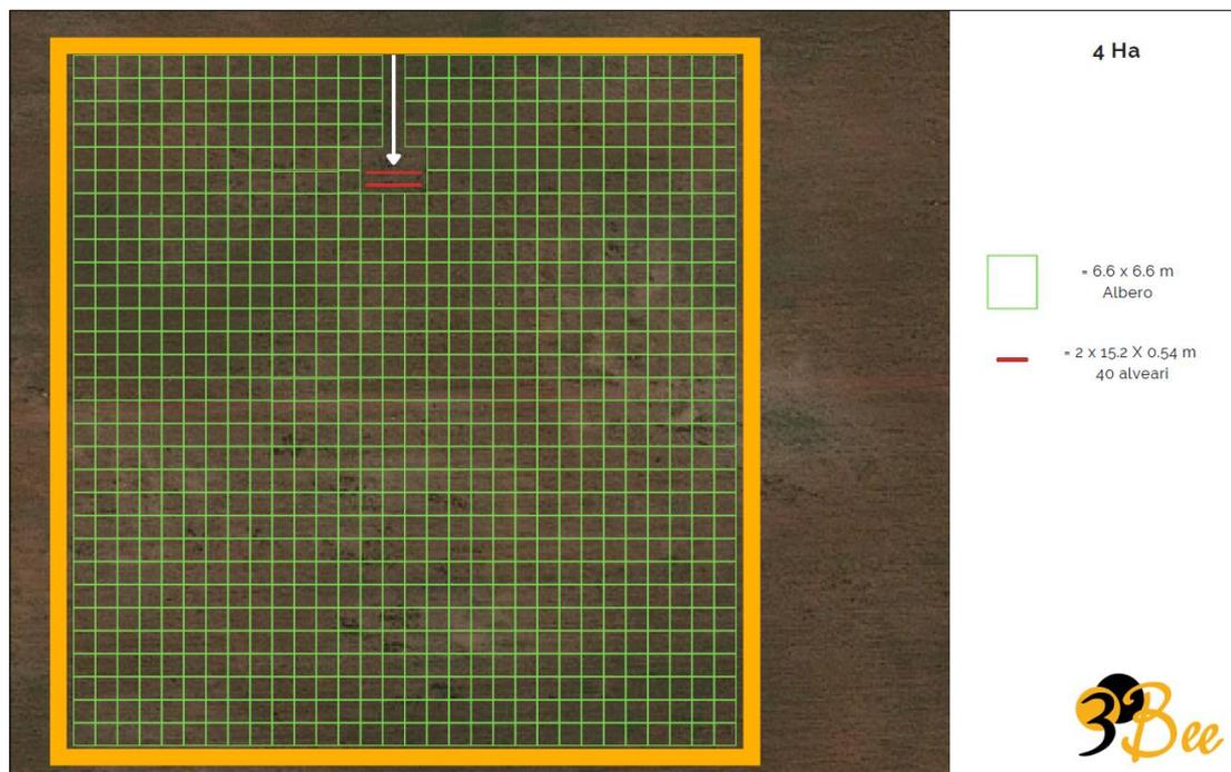
Figura 5 - Schema piantumazione e posizionamento alveari
