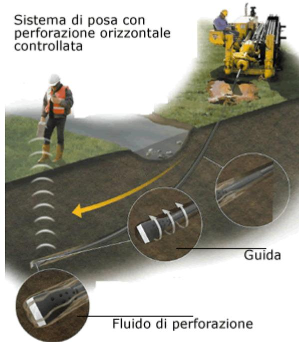
**Figure 12-Sistema di trivellazione orizzontale controllata (T.O.C.).**
