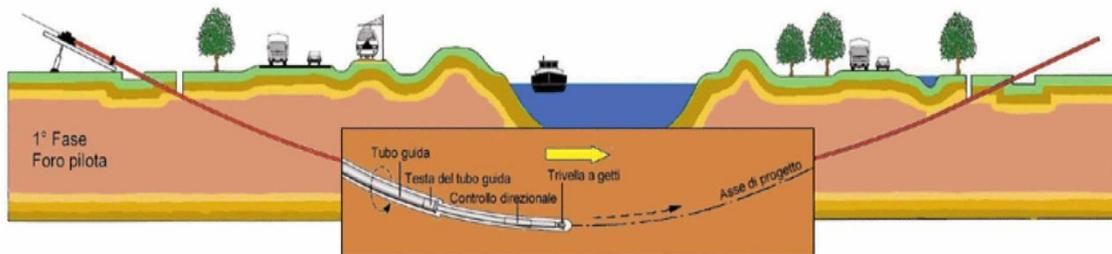
**Figure 13 – Schema della fase di realizzazione del foro pilota.**
