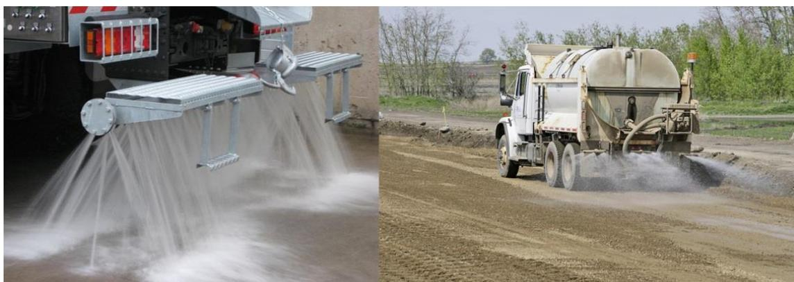
**Figura 5-16: Automezzo per la bagnatura delle piste sterrate**
