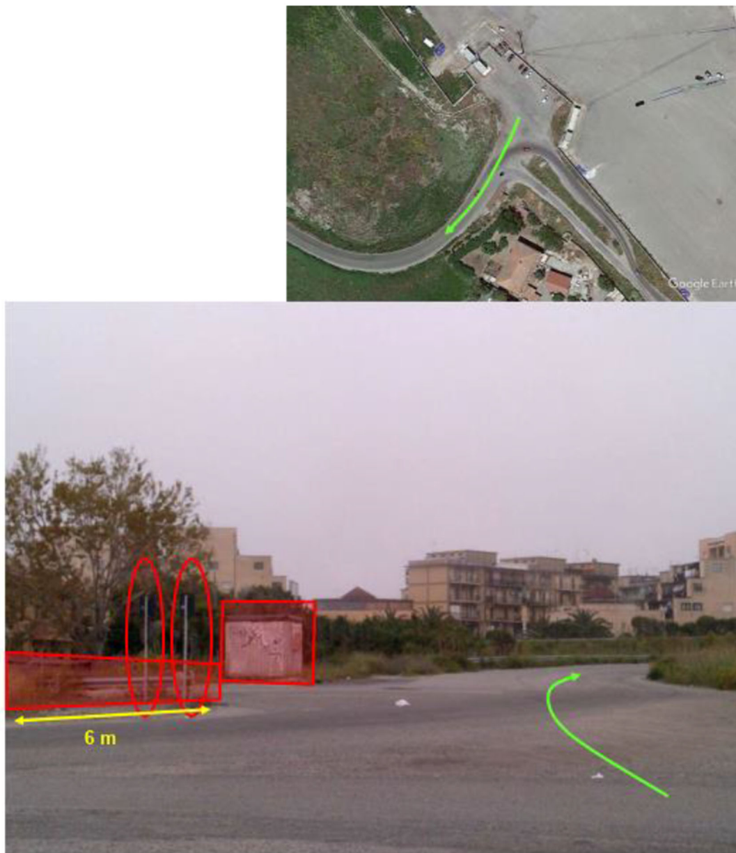
Fig.19-Rimozione temporanea segnali stradali, guard rail e cabina
