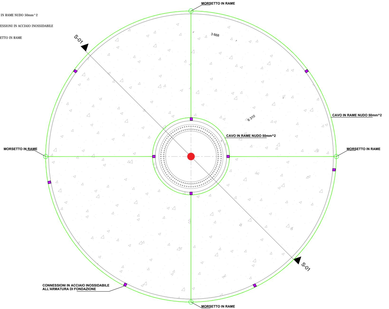
**SEZIONE S-01 PARTICOLARE RETE DI TERRA Scala 1:100**
