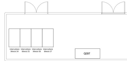
Pianta con apparecchiature cabina 3
