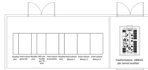
Pianta con apparecchiature cabina 1
