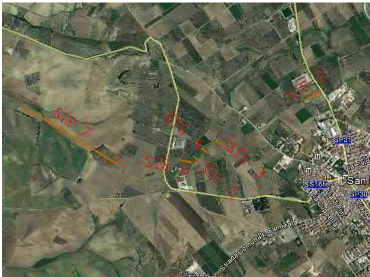
Figura 1 – Ubicazione schematica dei profili sismici effettuati
