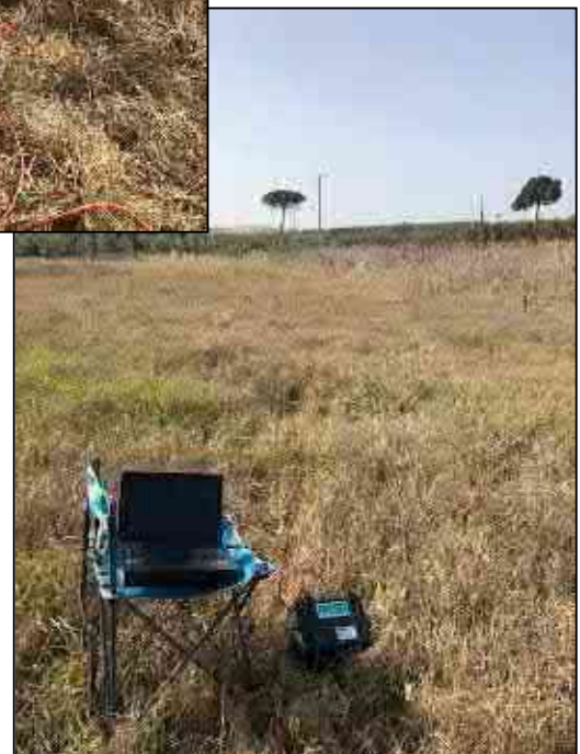
Foto 1 – Esecuzione del profilo sismico e della MASW n° 1
