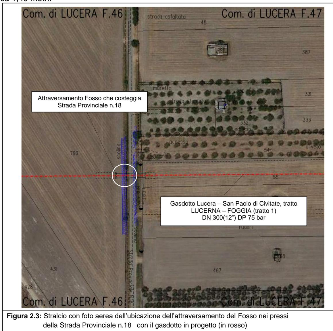
**Figura 2.3:** Stralcio con foto aerea dell'ubicazione dell'attraversamento del Fosso nei pressi della Strada Provinciale n.18 con il gasdotto in progetto (in rosso)
