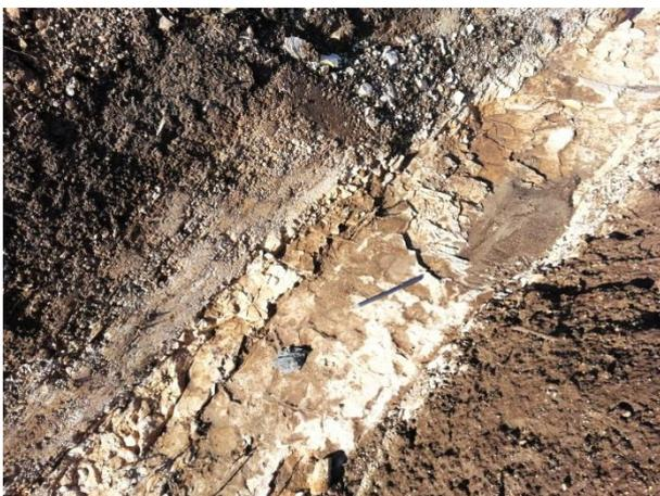
**Foto 6.1.E** - Substrato carbonatico della piattaforma apula
