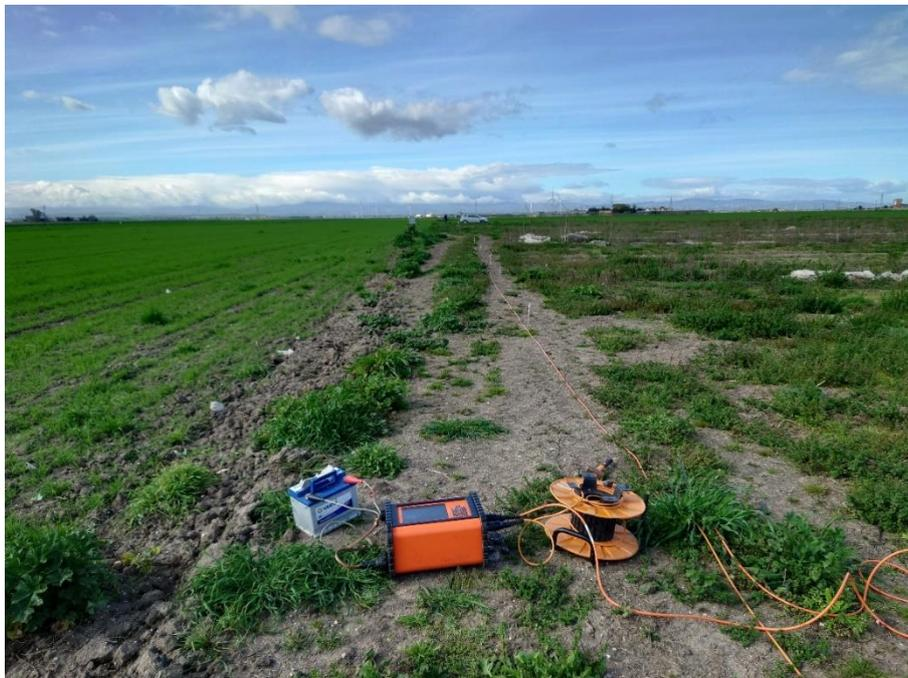
**Foto 6.2.E** - Fase di acquisizione dati prospezione ERT4
