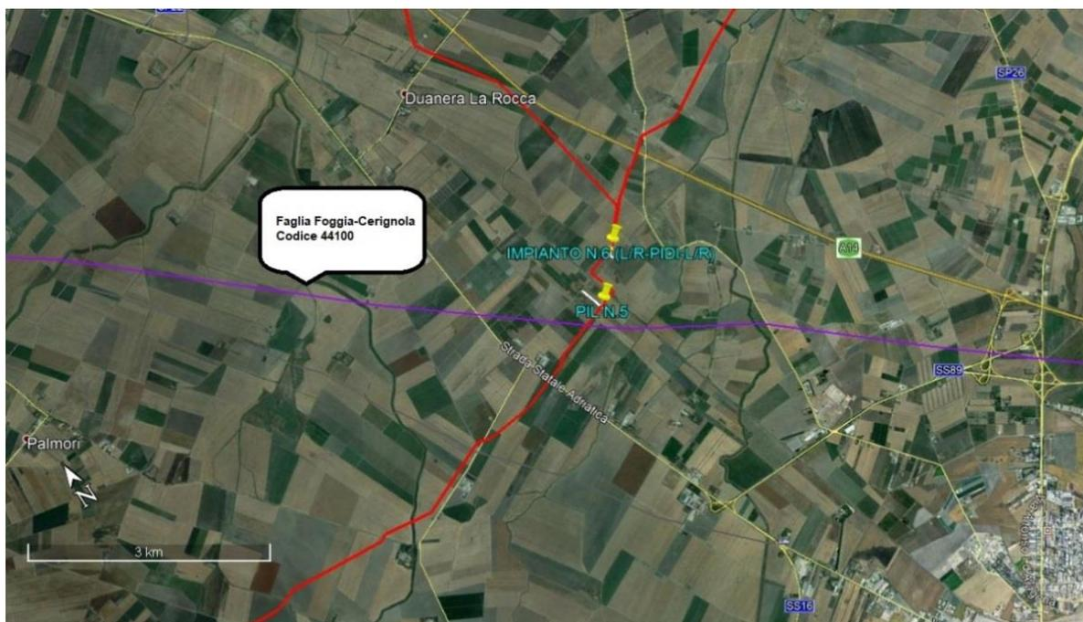
**Fig. 2.A** – Stralcio con ubicazione faglie attive e capaci estrapolato dal portale <http://sgi2.isprambiente.it/ithacaweb/viewer/index.html> dell’I.S.P.R.A.. Traccia faglia riportata in viola, interferente con il tracciato del gasdotto in progetto: Tratto Lucera-Foggia (Tratto 1)
