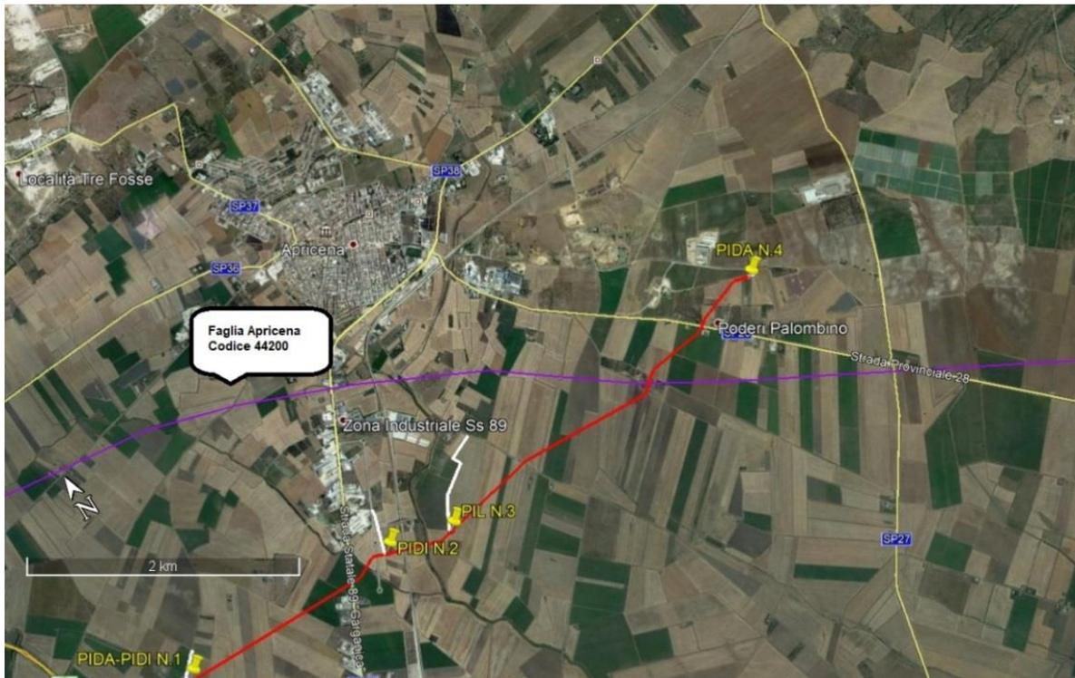
**Fig. 2.B** – Stralcio con ubicazione faglie attive e capaci estrapolato dal portale <http://sqi2.isprambiente.it/ithacaweb/viewer/index.html> dell'I.S.P.R.A.. Traccia faglia riportata in viola, interferente con il tracciato del gasdotto in progetto: Bretella 3 in Comune di Apricena.
