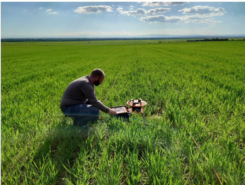
Fase di acquisizione dati prospezione ERT2
