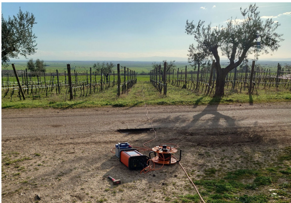
Fase di acquisizione dati prospezione ERT3
