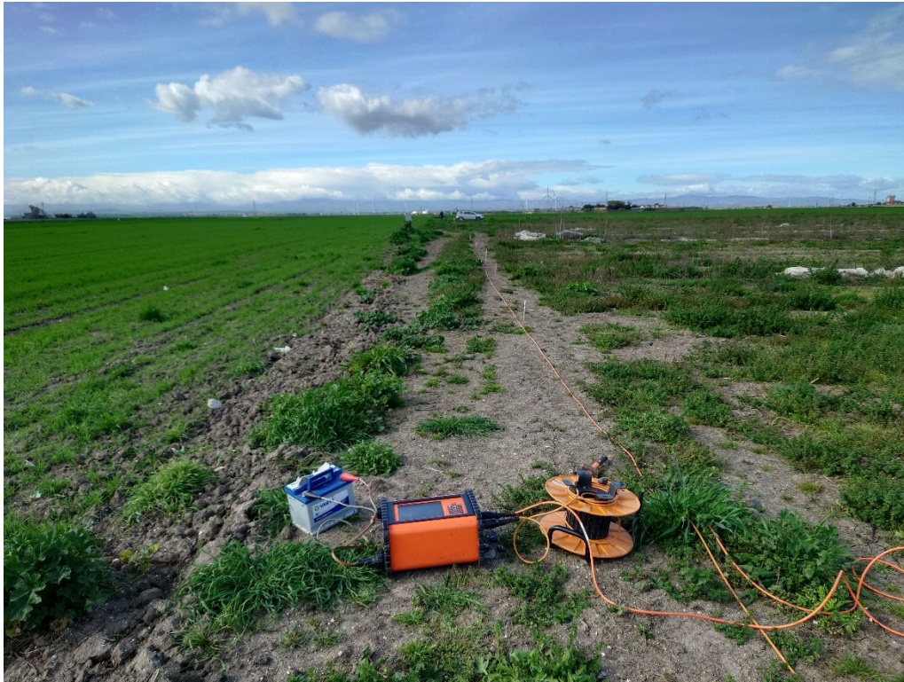
Fase di acquisizione dati prospezione ERT4
