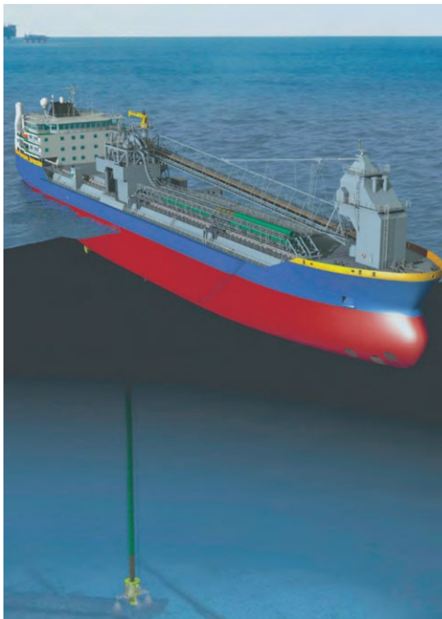
Figura 2.13 Esempio di nave equipaggiata con macchina per l'esecuzione di protezione mediante “rock dumping”
