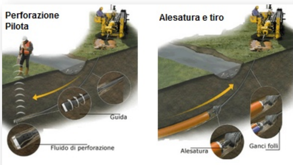
Figura 21 - tecnologia di trivellazione orizzontale controllata (TOC)
