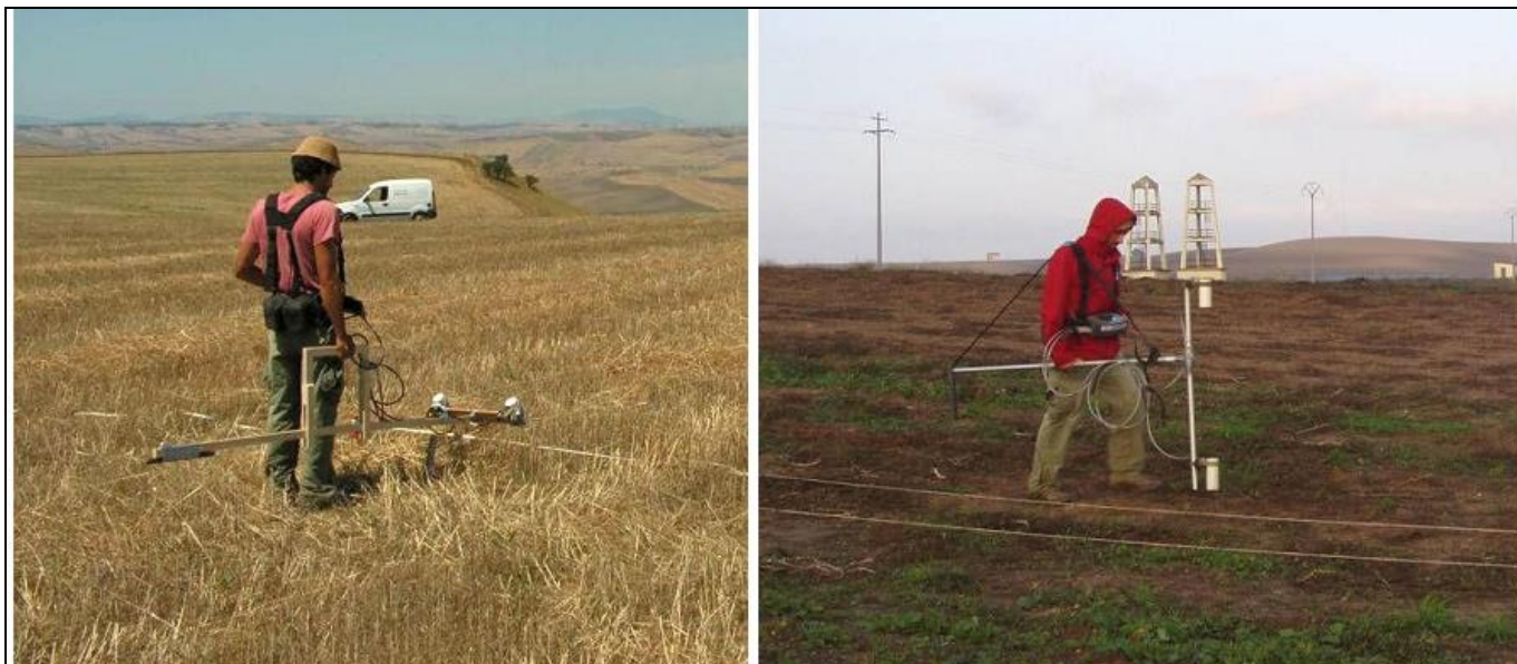
Figura 5 - Acquisizione dati magnetometrici: configurazione strumentale per misure di intensità di campo magnetico (sensori disposti in parallelo) e di gradiente (sensori disposti in verticale).
